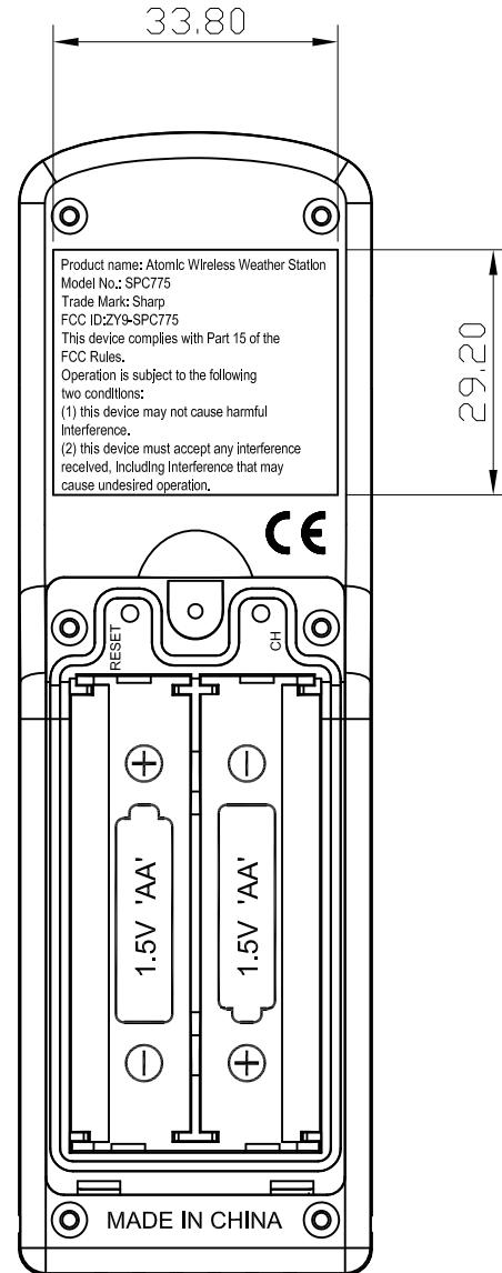
晒字要求：字和图型凸出胶件0.15MM
