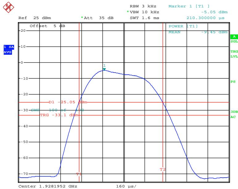
**FCC§15.323 (d) - EMISSION INSIDE AND OUTSIDE THE SUB-BAND****Applicable Standard**
