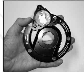
5. Führen Sie das große Kettenblatt über das Batteriefach.
