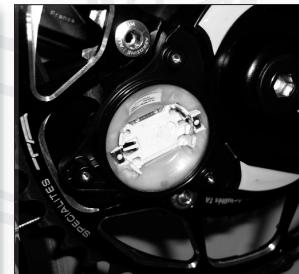
4. Legen Sie die mitgelieferte Batterie CR2450 der Firma RENATA ein. Achten Sie hierbei auf die richtige Polarität. Der PLUS-Pol (Schriftseite der Batterie) muss nach dem Einlegen sichtbar sein.
