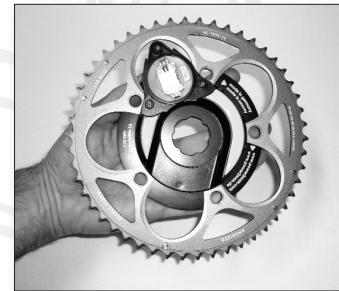
7. Nachdem Sie das kleine Kettenblatt von hinten an den Leistungsmesser **power2max** herangeführt haben, verschrauben Sie alles mit den dafür notwendigen Kettenblattschrauben.
