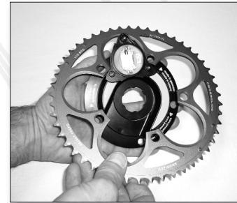
6. Bringen Sie die Löcher für die Schraubverbindungen in Über-einstimmung.
