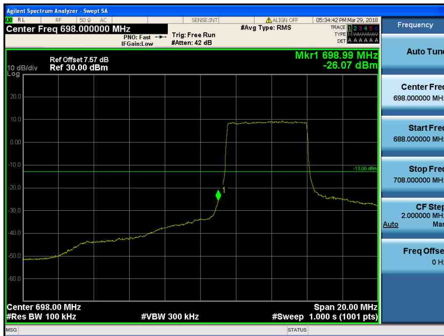
LTE Band 12,17 / 10MHz / QPSK - RB Size/Offset (25/0)
