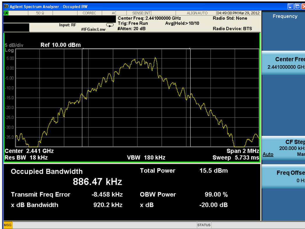
Plot 6-2. 20dB Bandwidth Plot (Bluetooth, 1Mbps – Ch. 39)
