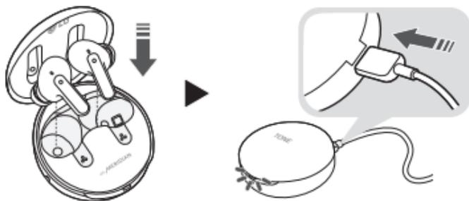
Cuando el cable de carga es conectado, el estado de carga se visualiza en el estuche de carga.
