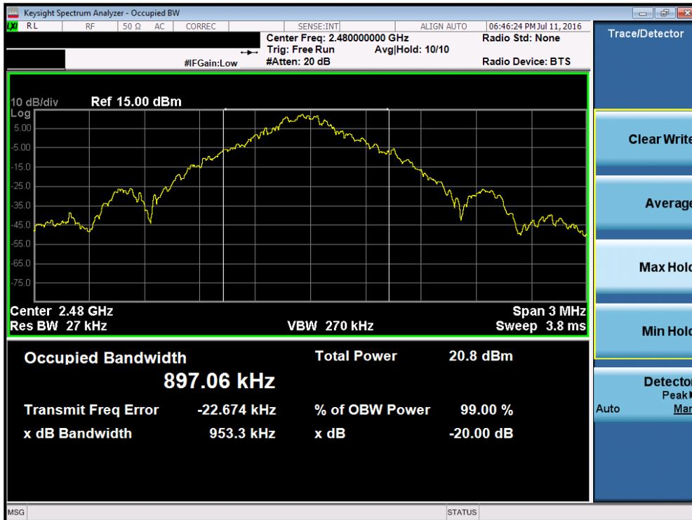
Plot 7-3. 20dB Bandwidth Plot (Bluetooth, 1Mbps – Ch. 78)
