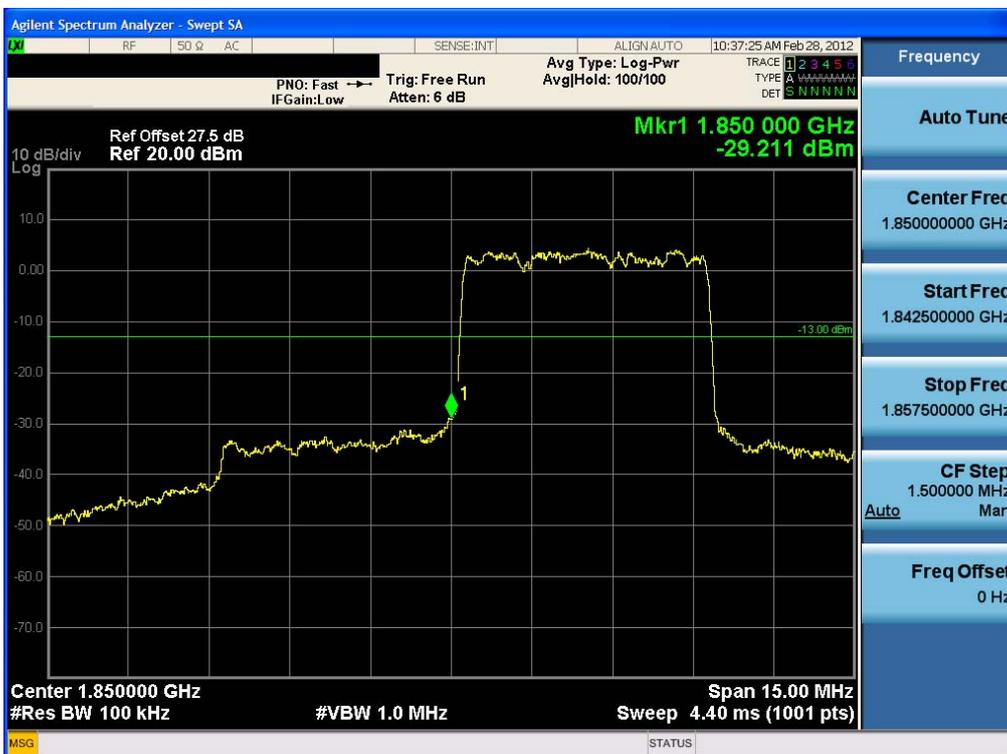
Band Edge Plot (5.0 MHz BW, QPSK, Band 25: HIGH CH)
