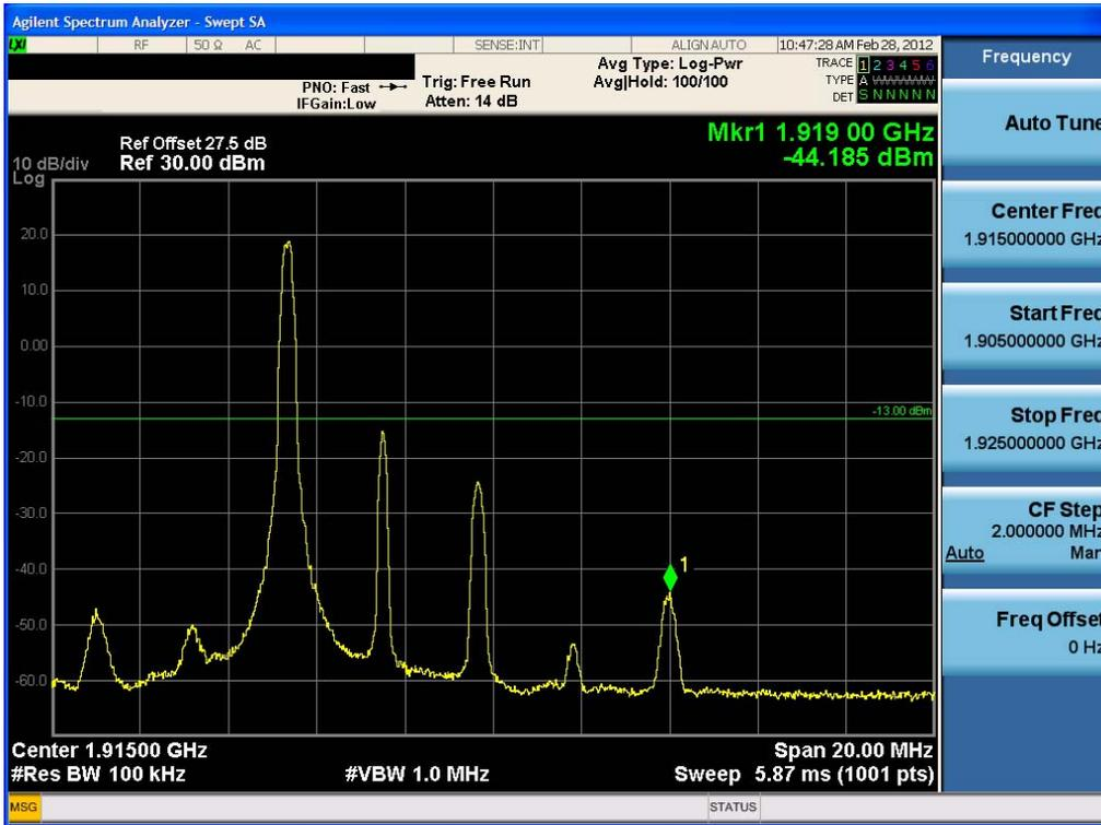
Band Edge Plot (5.0 MHz BW, 16-QAM, Band 25: HIGH CH)
