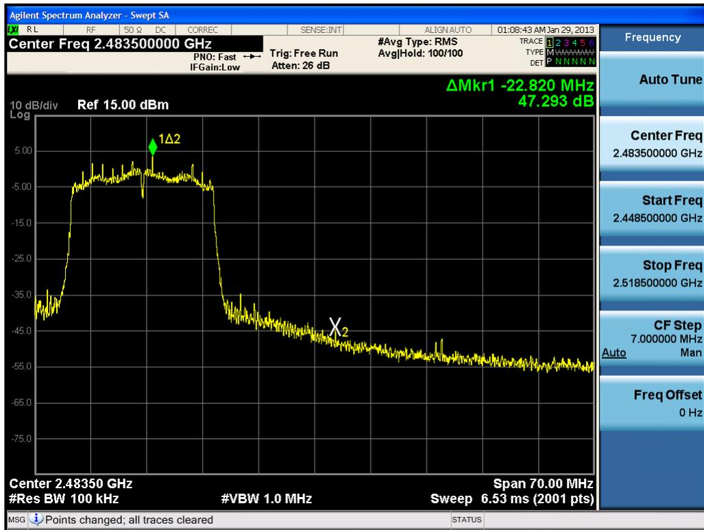
Plot 6-24. Band Edge Plot (802.11n (2.4GHz) – Ch. 11)
