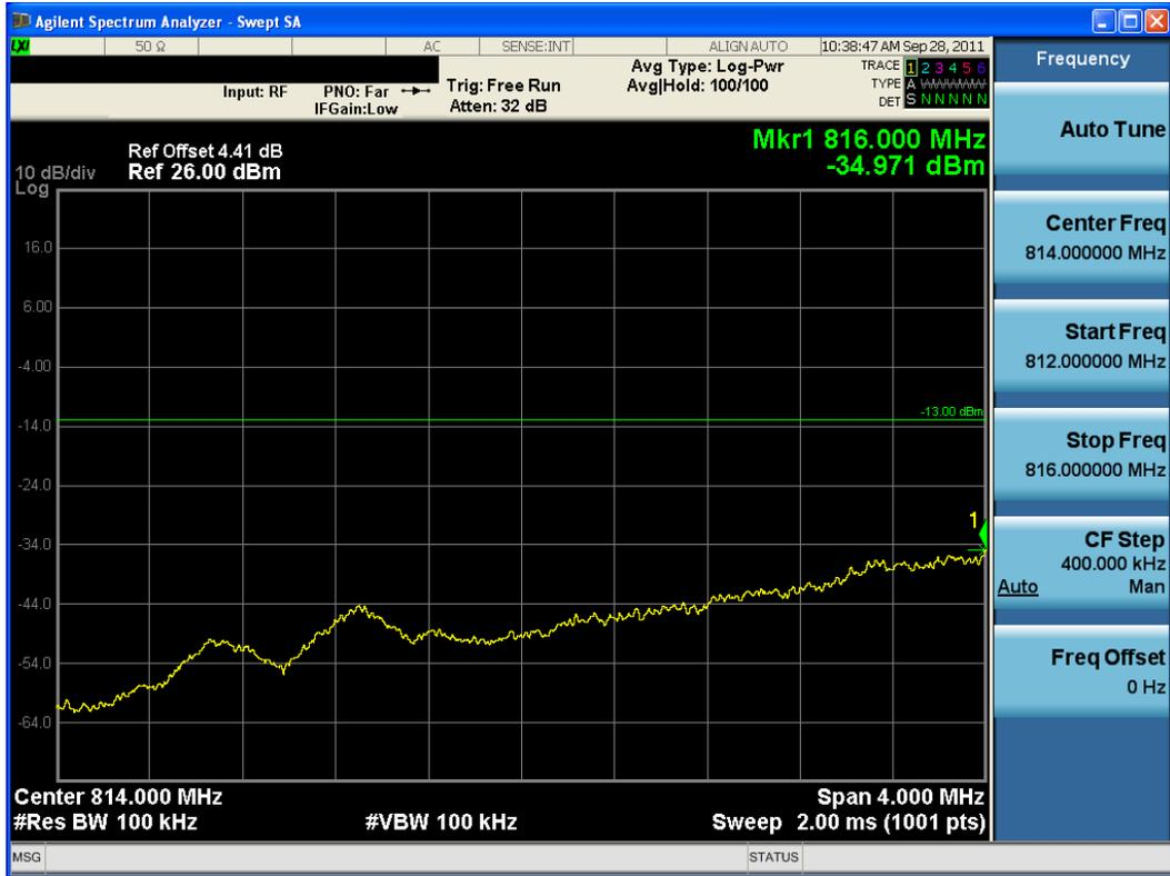
Plot 7-5. 4MHz Span Plot (BC10 CDMA Ch. 476)
