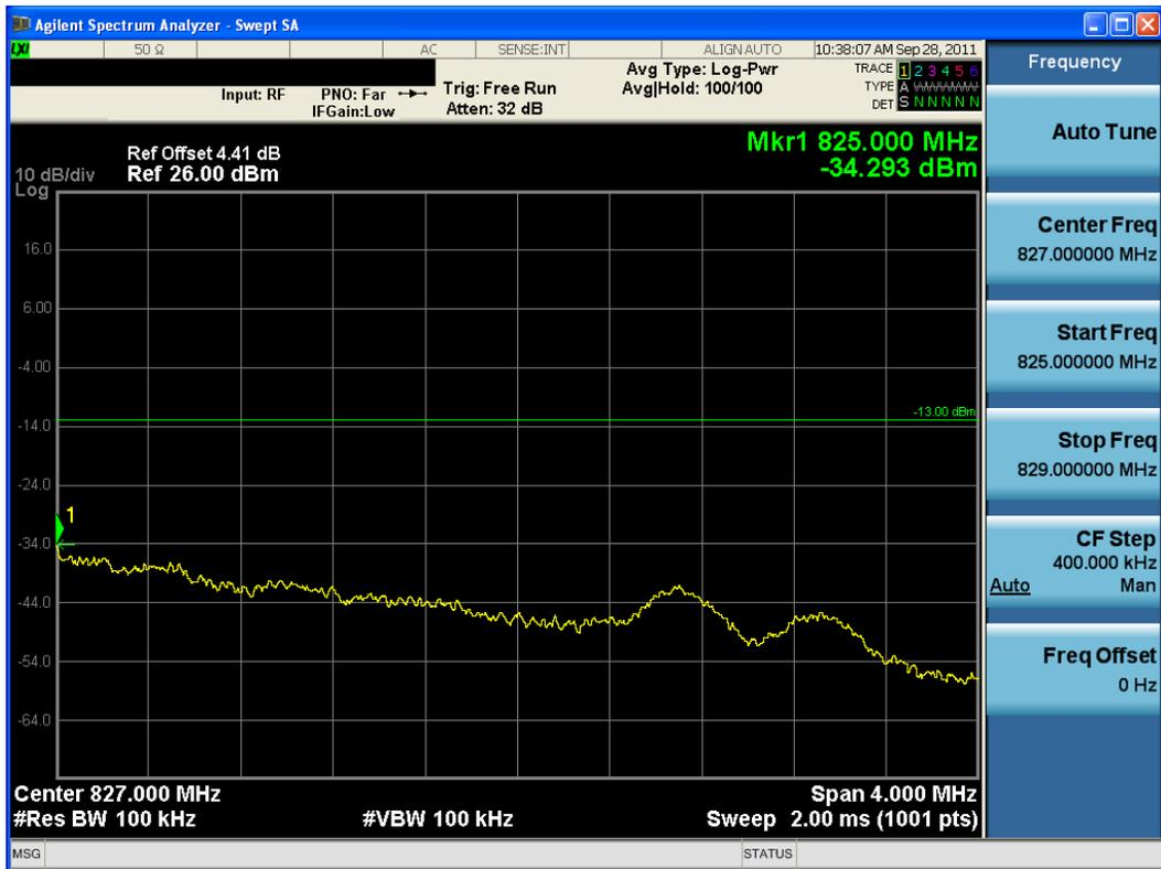
Plot 7-10. 4MHz Span Plot (BC10 CDMA Ch. 684)
