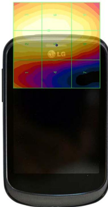
Figure 18-4 E-Field WD Scan overlay
