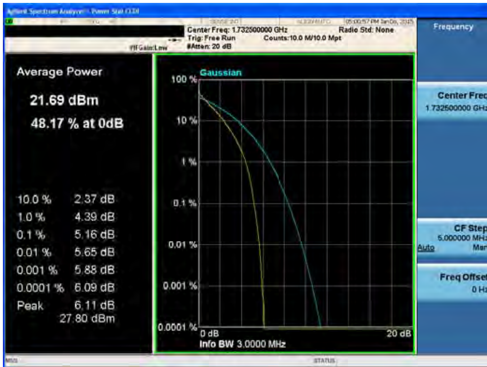
BAND 4. PAR Plot (3M BW_Ch.20175_QPSK_RB15_0)
