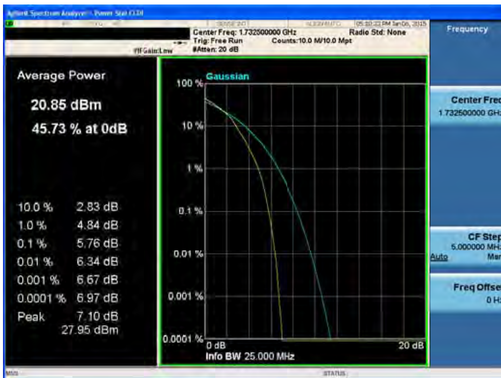
BAND 4. PAR Plot (15M BW_Ch.20175_16QAM_RB75_0)
