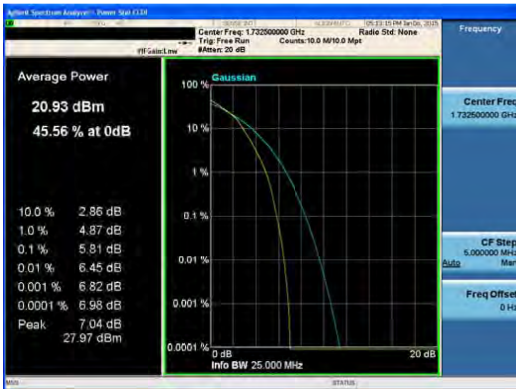
BAND 4. PAR Plot (20M BW_Ch.20175_16QAM_RB100_0)
