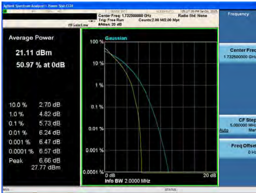
BAND 4. PAR Plot (1.4M BW_Ch.20175_QPSK_RB6_0)
