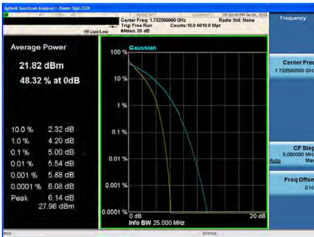
BAND 4. PAR Plot (15M BW_Ch.20175_QPSK_RB75_0)
