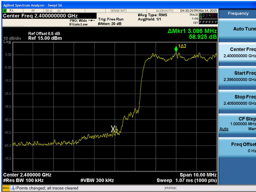
Test Plots without hopping ( $\pi/4$ DQPSK)
