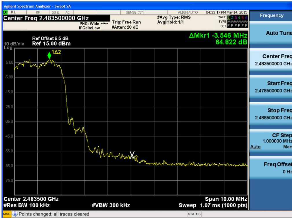
Test Plots without hopping ( $\pi/4$ DQPSK)
