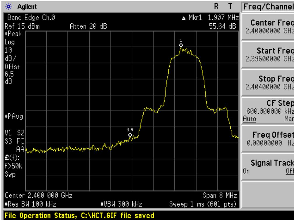
Test Plots without hopping ( $\pi/4$ DQPSK)
