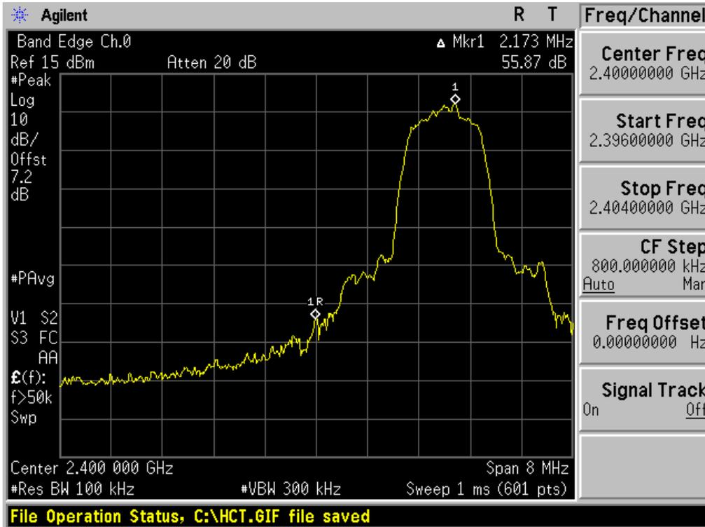
Test Plots without hopping ( $\pi/4$ DQPSK)
