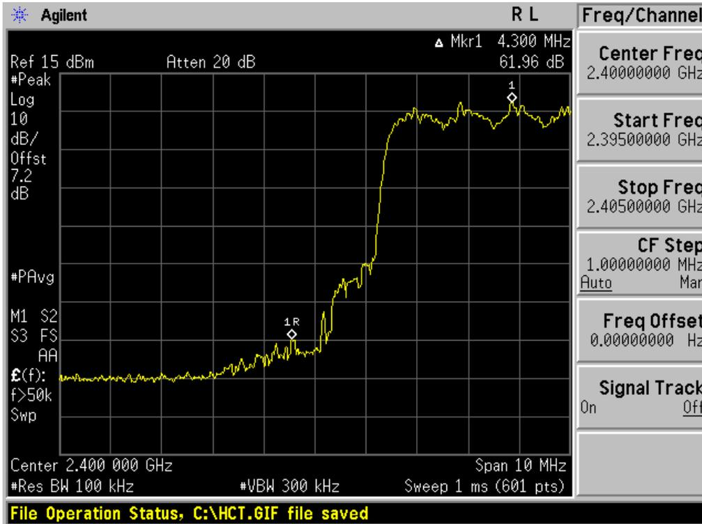
Test Plots with hopping ( $\pi/4$ DQPSK)
