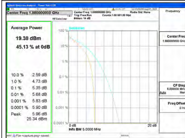
B2 / 1.4MHz / Mid CH / QPSK
