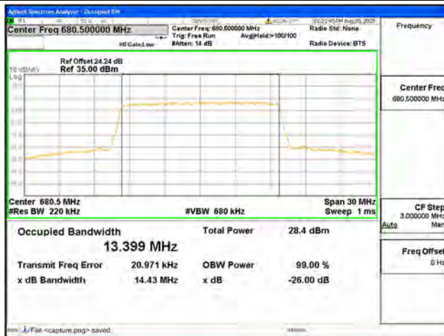
B71 / 15MHz / QPSK/ Mid CH
