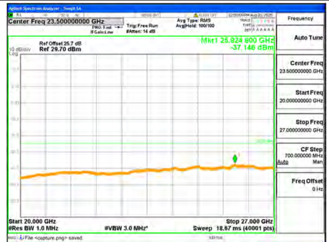
B41-20G-27G / 5MHz / Mid CH / QPSK
