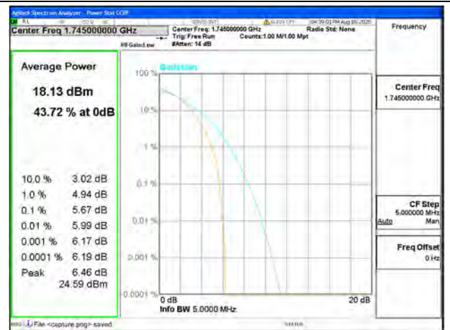
B66 / 1.4MHz / Mid CH / 16QAM
