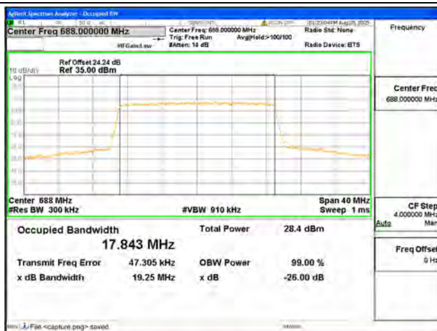
B71 / 20MHz / QPSK/ High CH
