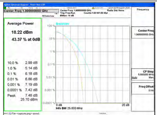
B2 / 20MHz / High CH / 16QAM
