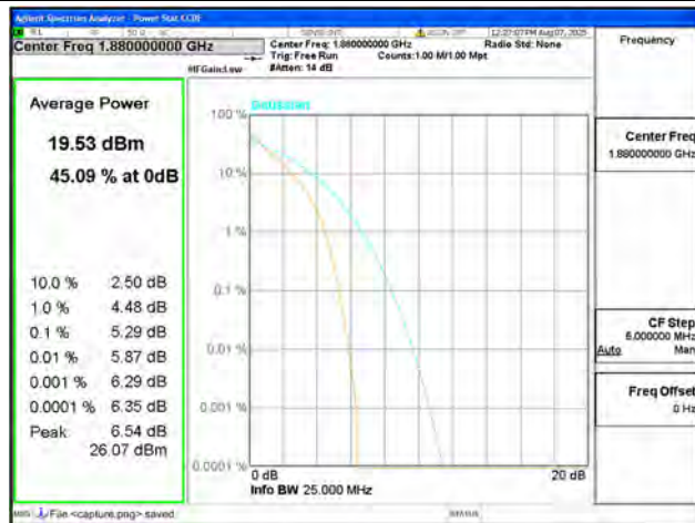
B2 / 20MHz / Mid CH / QPSK
