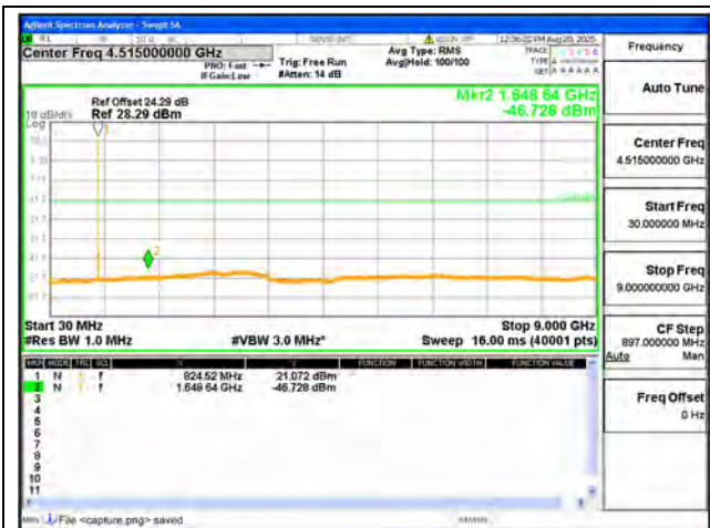
B26 Part22 / 1.4MHz / Low CH / QPSK
