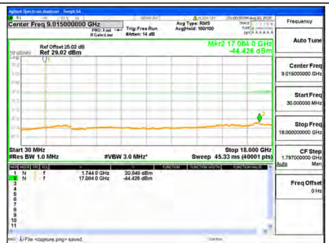
B66 / 1.4MHz / Mid CH / QPSK
