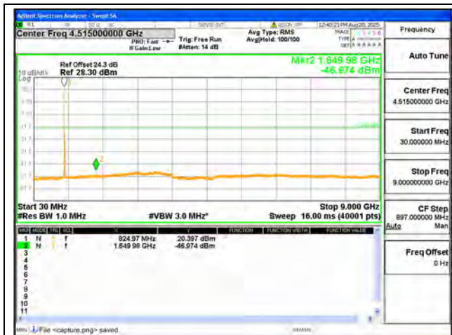
B26 Part22 / 15MHz / Low CH / QPSK
