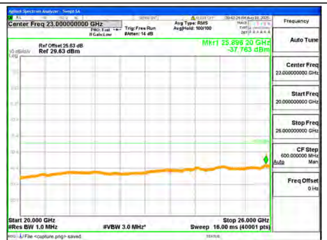
B7-20G-26G / 10MHz / Low CH / QPSK
