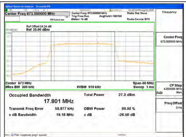
B71 / 20MHz / 16QAM/ Low CH
