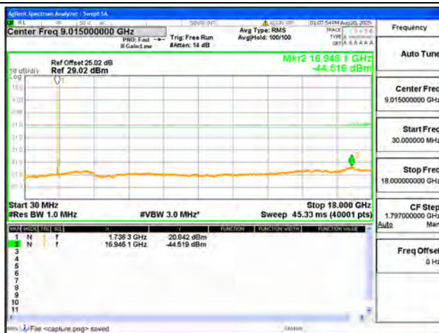
B66 / 20MHz / Mid CH / QPSK
