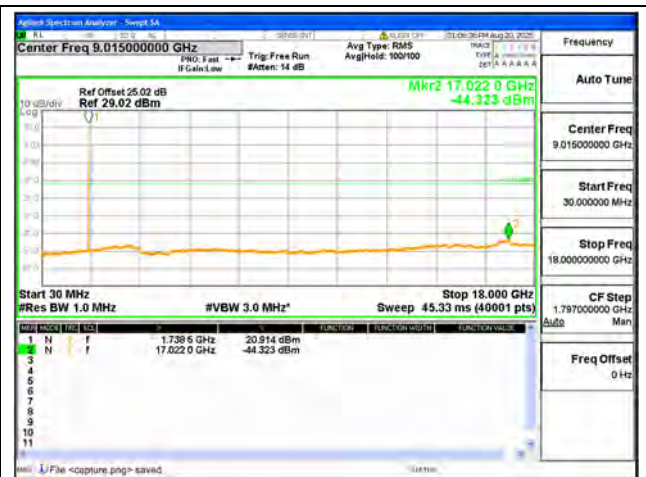
B66 / 15MHz / Mid CH / QPSK
