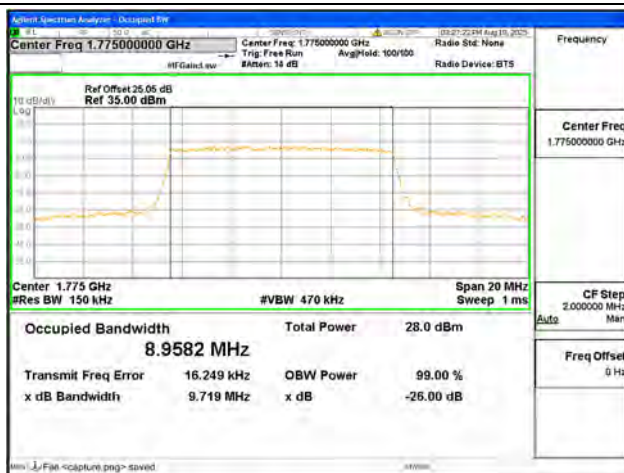
B66 / 10MHz / QPSK/ High CH
