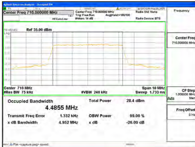
B17 / 5MHz / QPSK/ Mid CH
