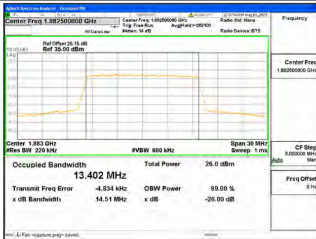
B25 / 15MHz / QPSK/ Mid CH
