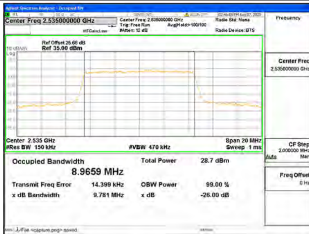
B7 / 10MHz / QPSK/ Mid CH
