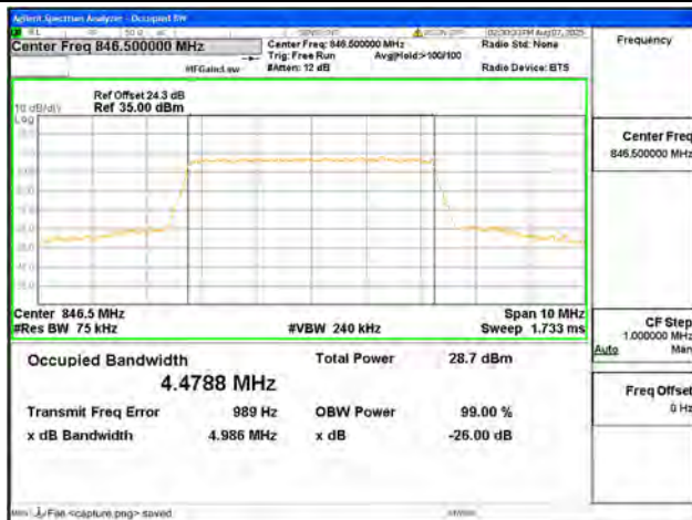
B5 / 5MHz / QPSK/ High CH
