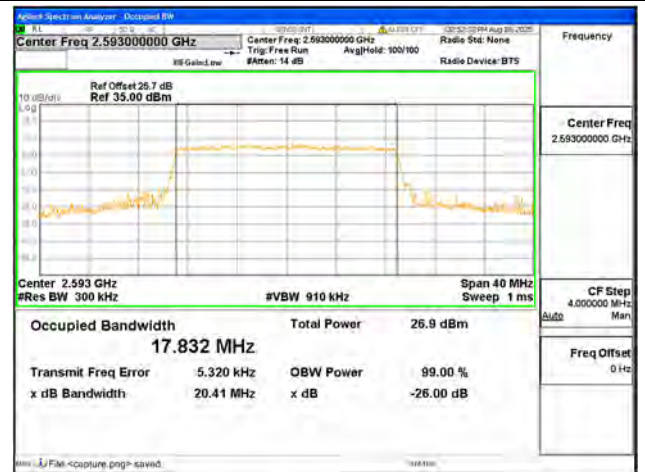
B41 / 20MHz / 16QAM/ Mid CH
