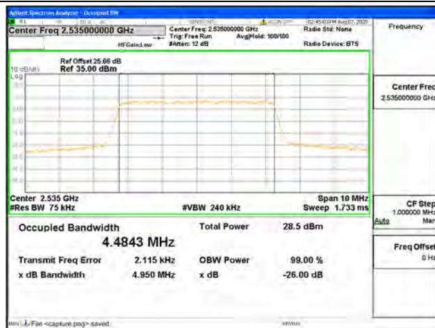
B7 / 5MHz / QPSK/ Mid CH
