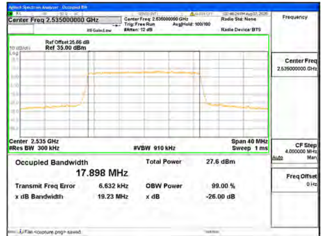
B7 / 20MHz / 16QAM/ Mid CH
