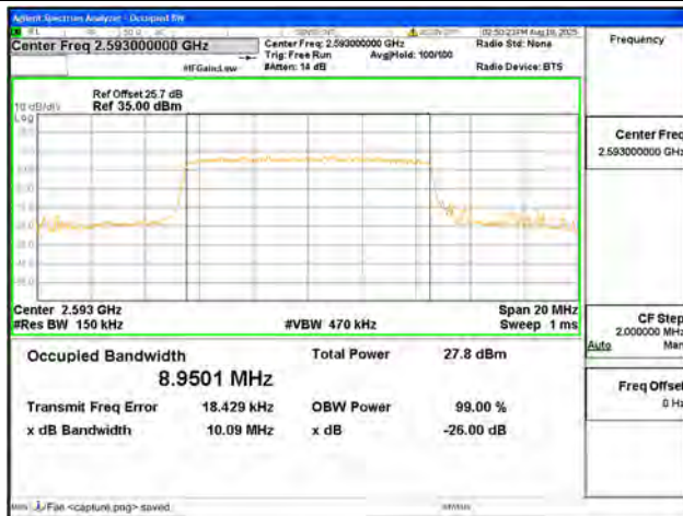
B41 / 10MHz / QPSK/ Mid CH
