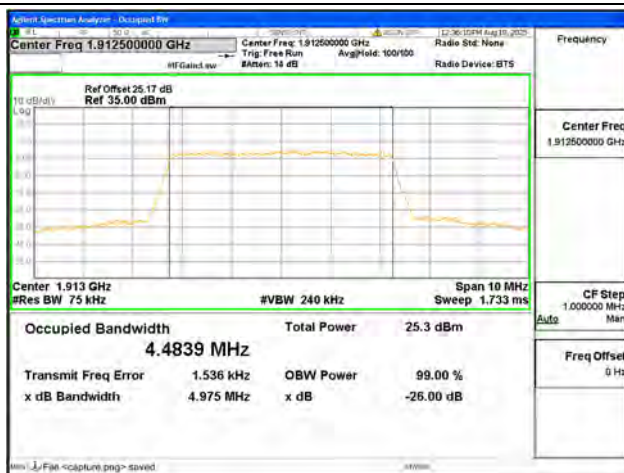
B25 / 5MHz / QPSK/ High CH
