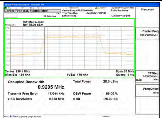
B5 / 10MHz / 16QAM/ Mid CH
