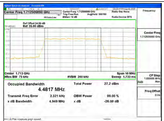
B66 / 5MHz / 16QAM/ Low CH
