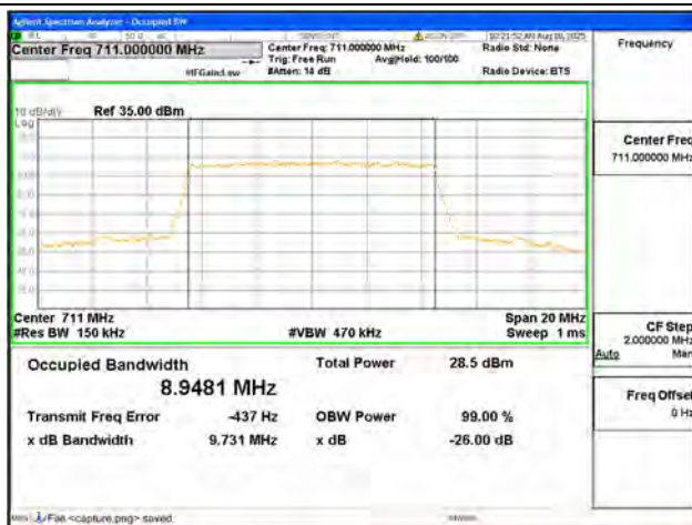
B17 / 10MHz / QPSK/ High CH
