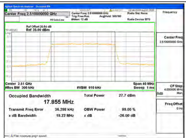
B7 / 20MHz / 16QAM/ Low CH
