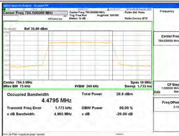
B13 / 5MHz / QPSK/ High CH
