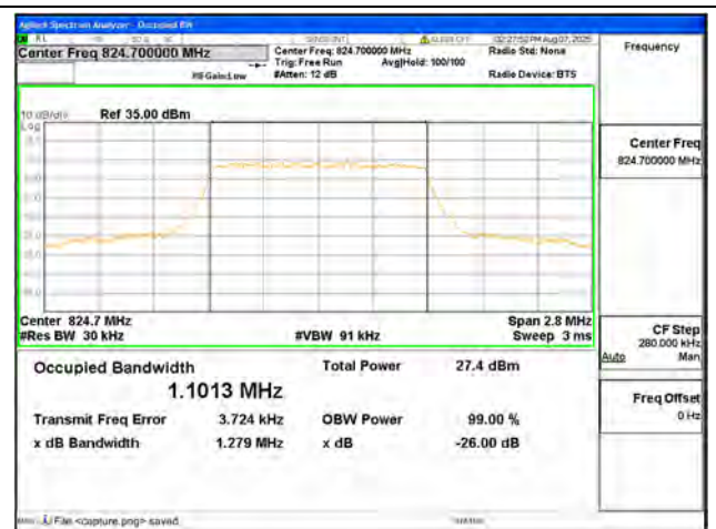
B5 / 1.4MHz / 16QAM/ Low CH
