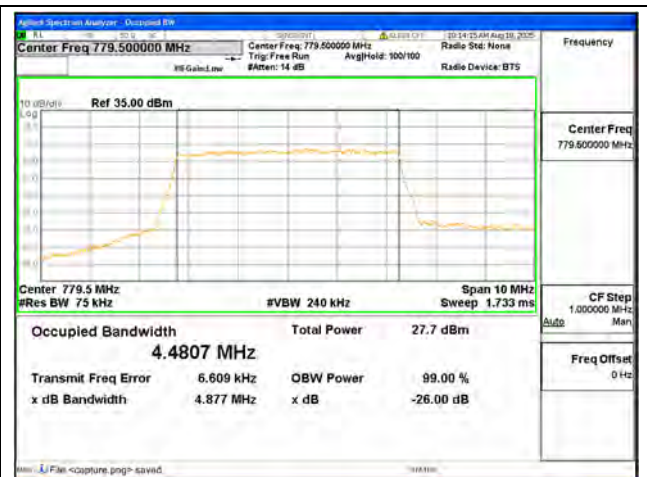
B13 / 5MHz / 16QAM/ Low CH
