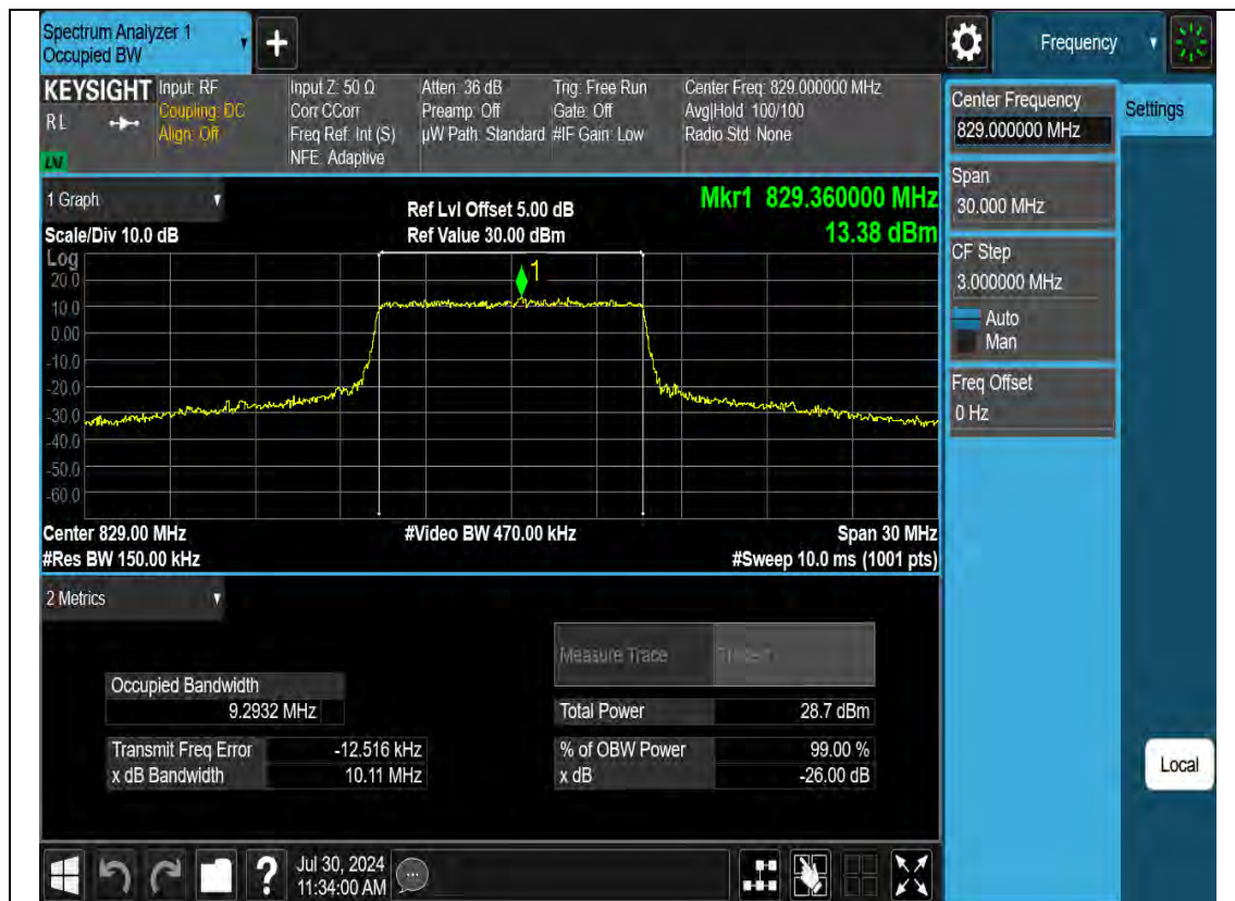
N26a(824-849MHz)-10M-OBW-M-DFT-s-OFDM-Pi2 BPSK
