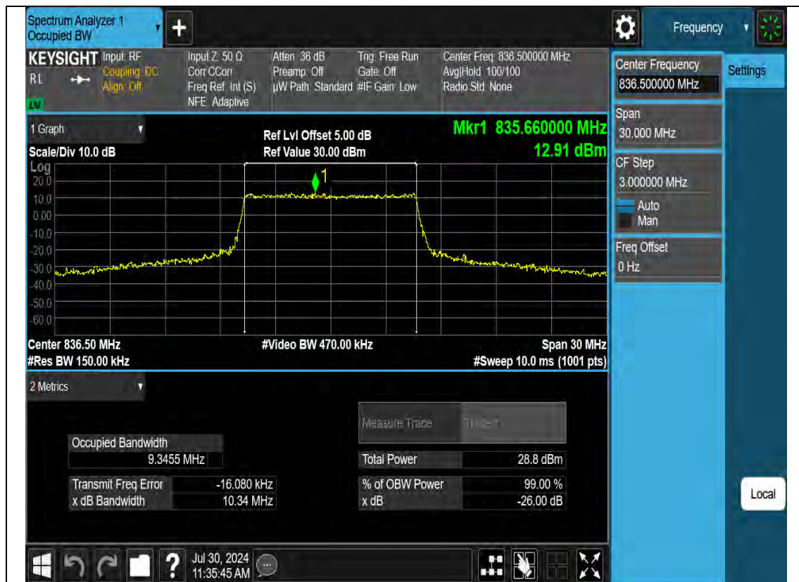
N26a(824-849MHz)-10M-OBW-H-DFT-s-OFDM-Pi2 BPSK
