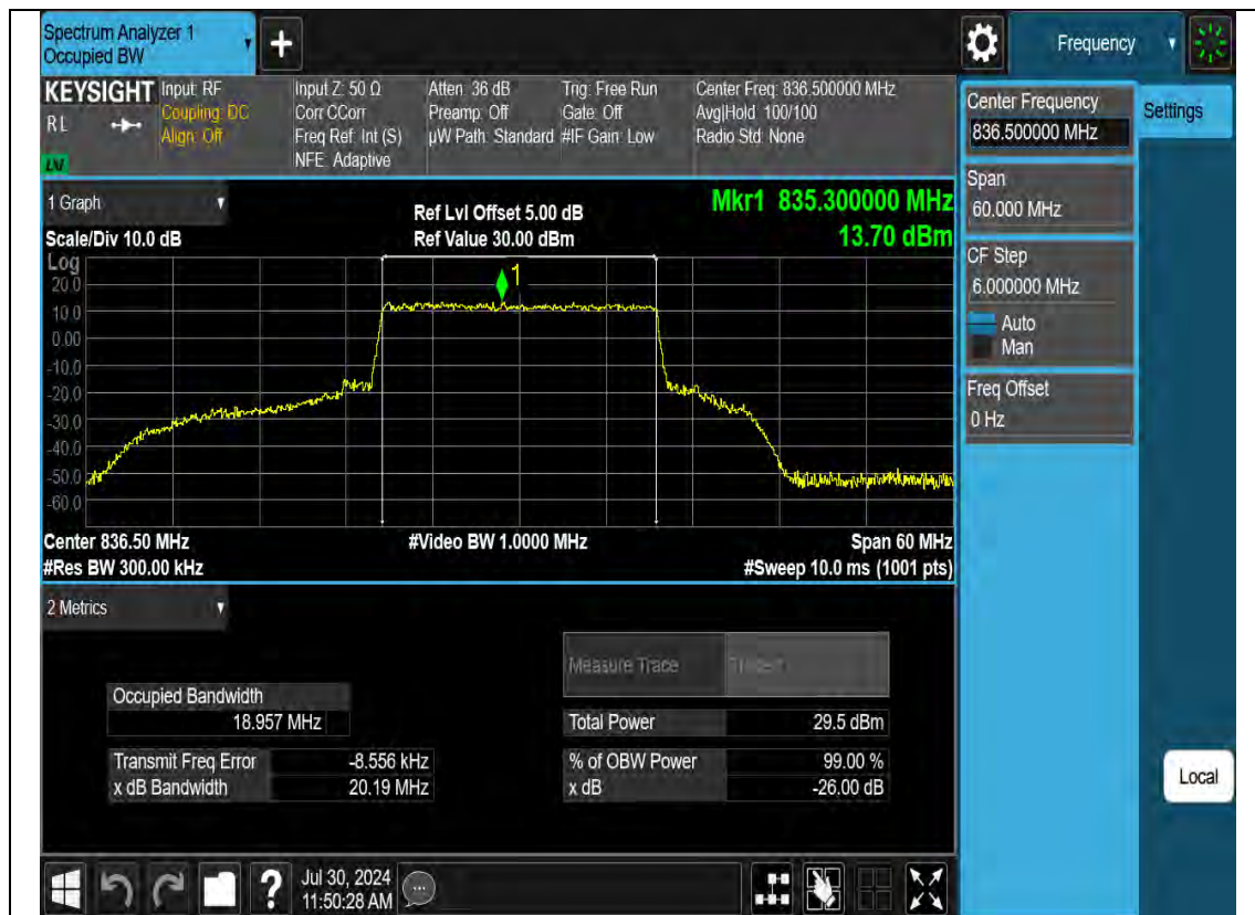
N26a(824-849MHz)-20M-OBW-H-DFT-s-OFDM-Pi2 BPSK
