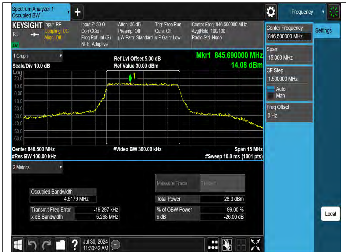
N26a(824-849MHz)-10M-OBW-L-DFT-s-OFDM-Pi2 BPSK
