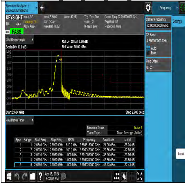
Band41 5MHz QPSK 41565 1RB#24
