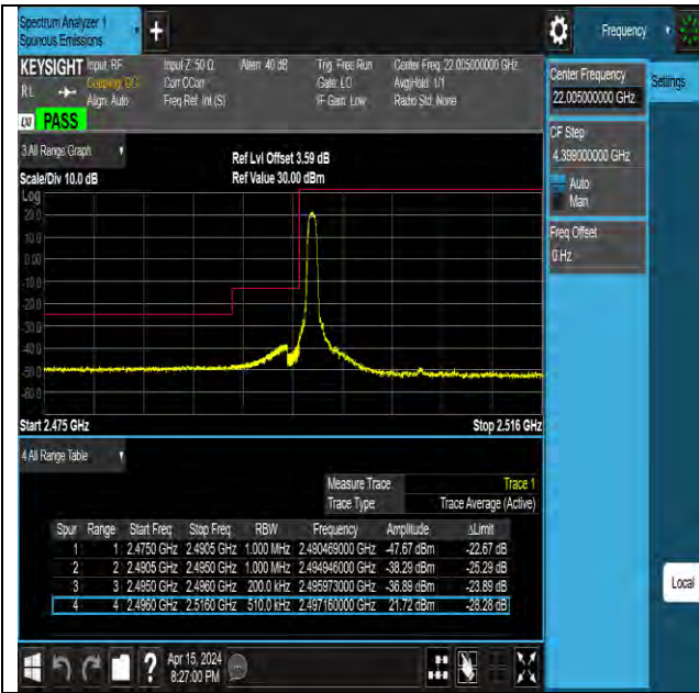
Band41 20MHz 16QAM 39750 1RB#0
