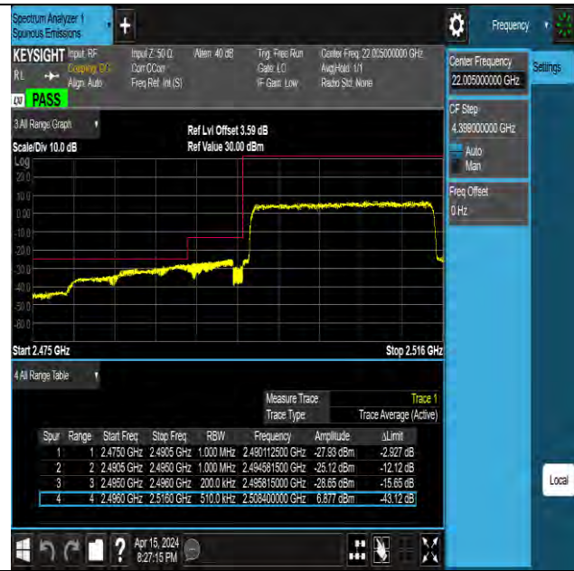
Band41 20MHz QPSK 39750 100RB#0
