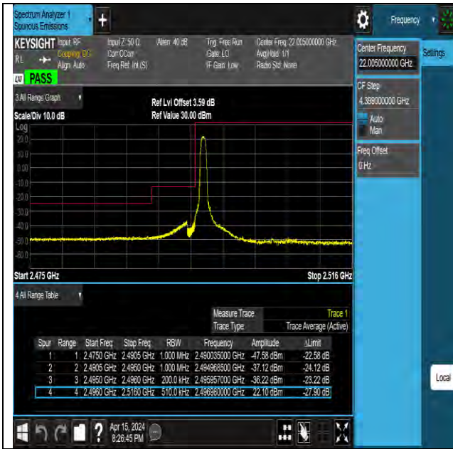
Band41 20MHz QPSK 39750 1RB#0
