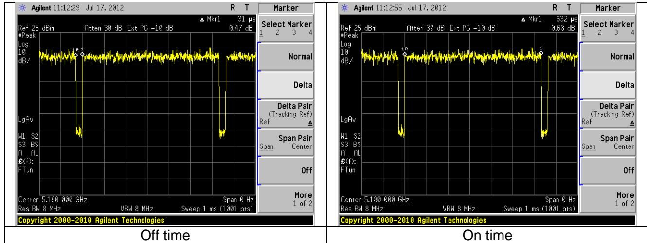
Duty Cycle = Tx On / (Tx On + TxOff)
