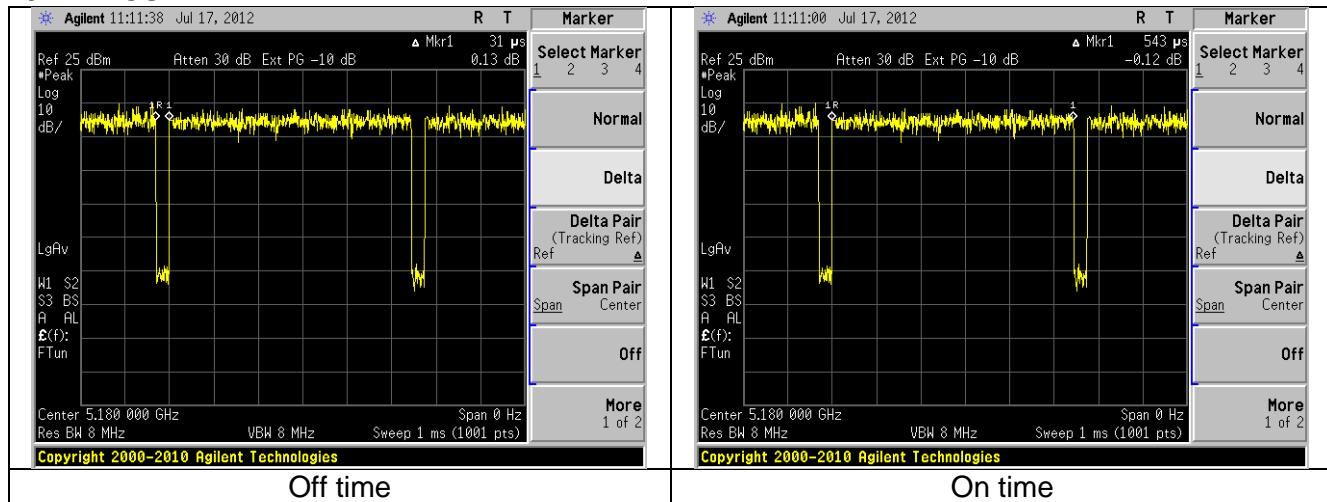
Duty Cycle = Tx On / (Tx On + TxOff)
