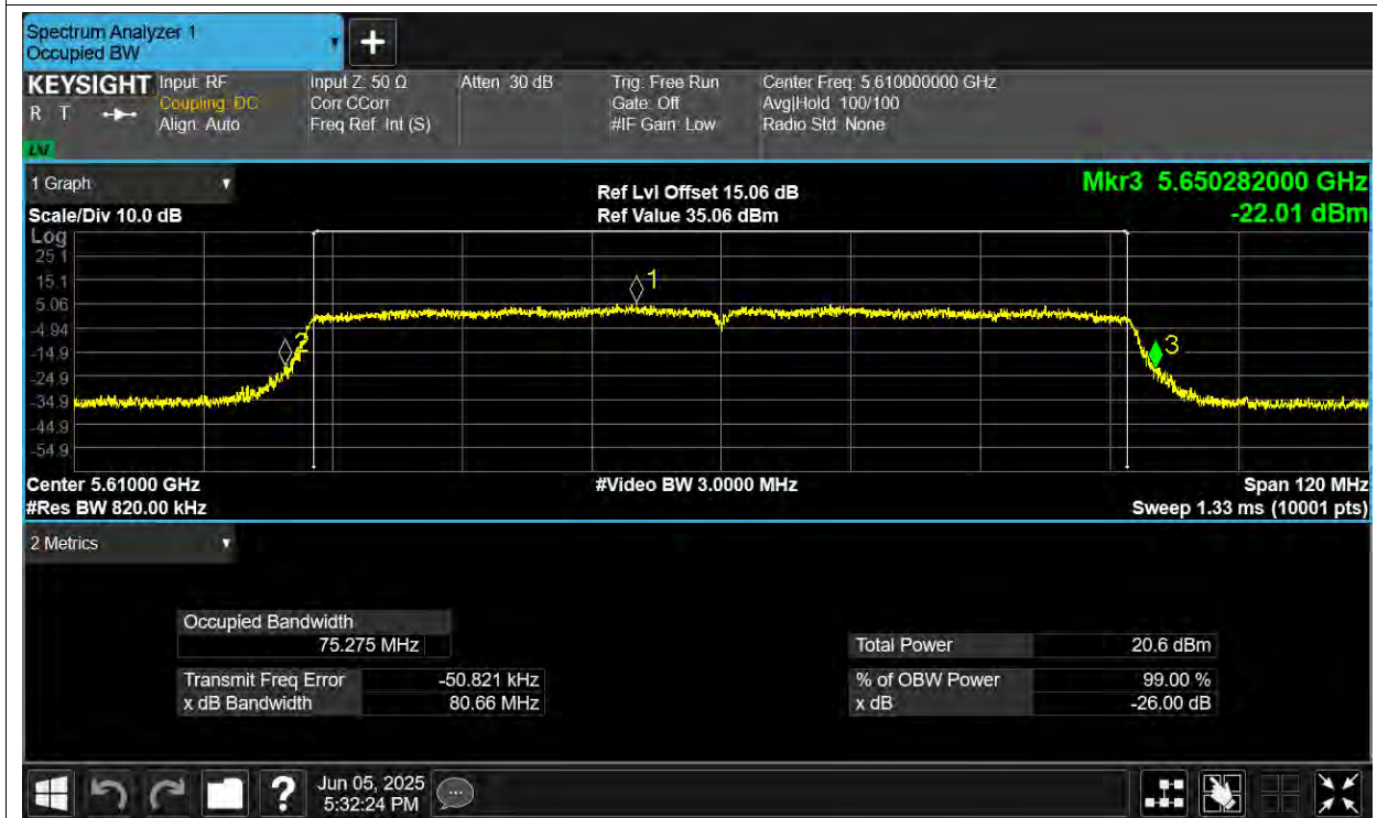
-26dB Bandwidth NVNT ax160 5570MHz Ant1
