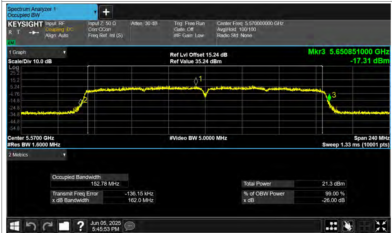
-26dB Bandwidth NVNT ac20 5500MHz Ant1
