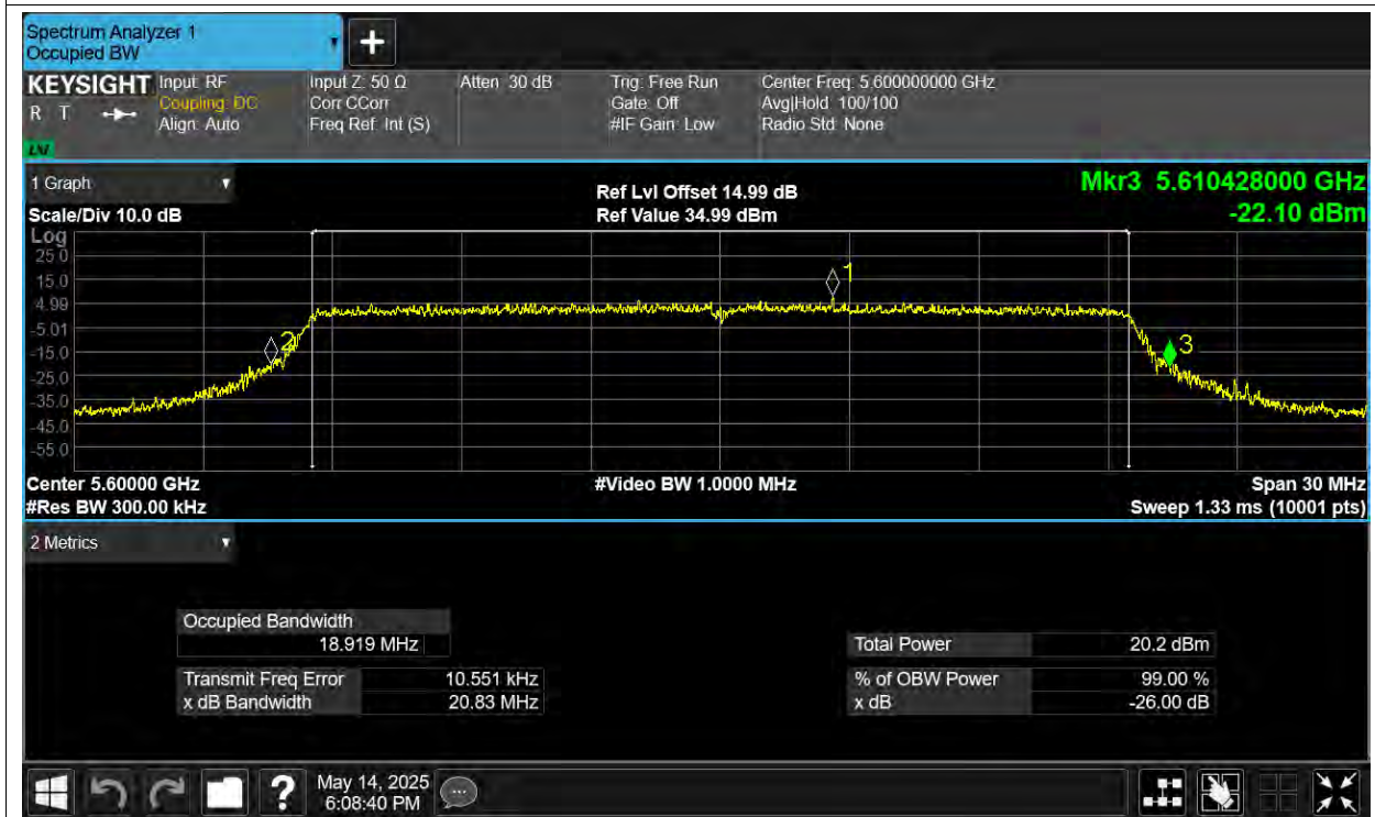
-26dB Bandwidth NVNT ax20 5700MHz Ant1
