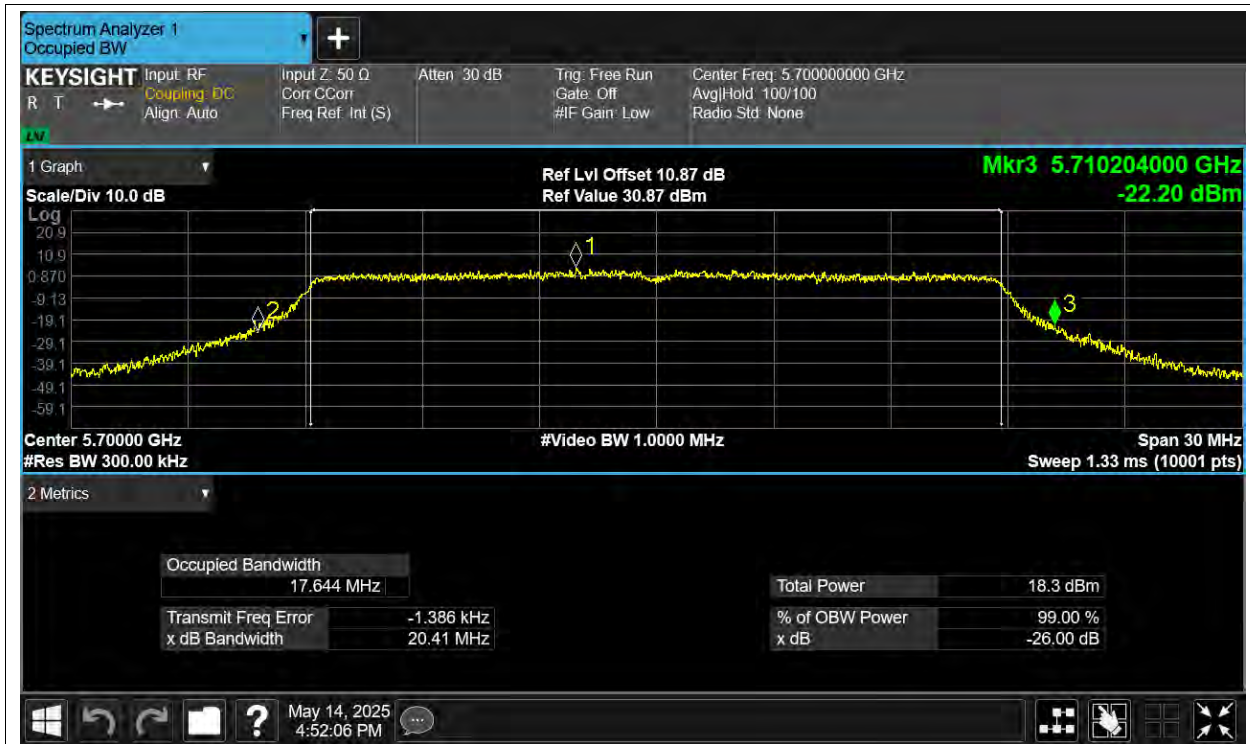
-26dB Bandwidth NVNT n20 5700MHz Ant4
