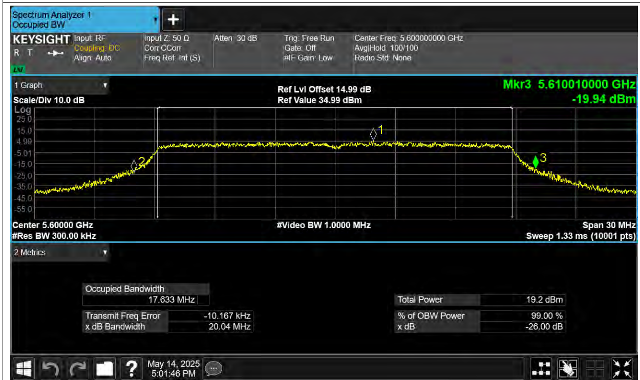
-26dB Bandwidth NVNT n20 5700MHz Ant1
