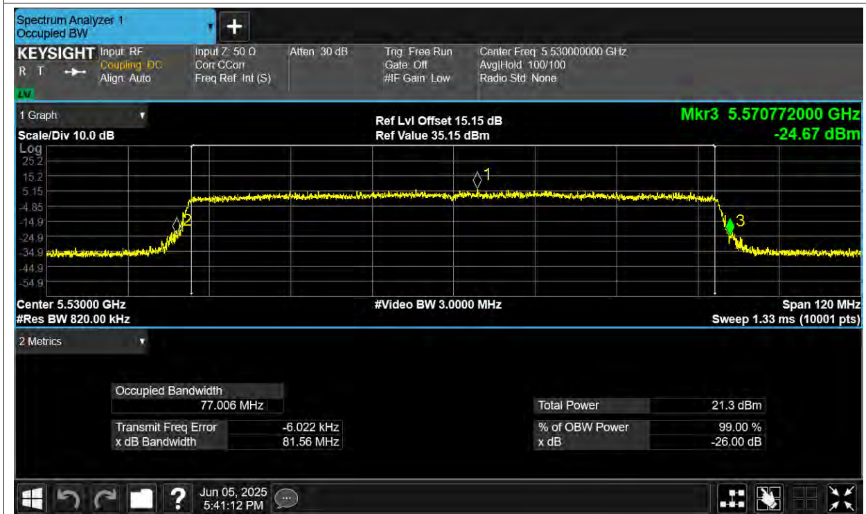
-26dB Bandwidth NVNT ax80 5610MHz Ant1
