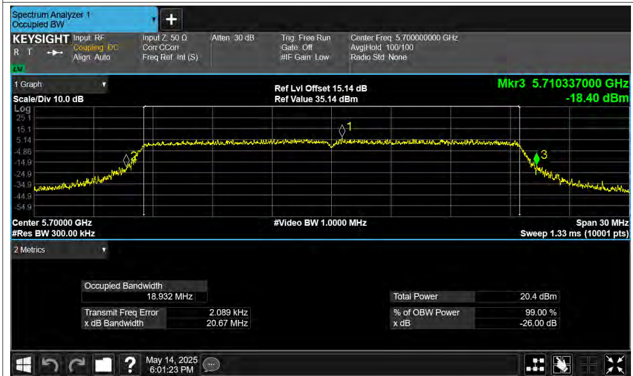
-26dB Bandwidth NVNT ax40 5510MHz Ant1
