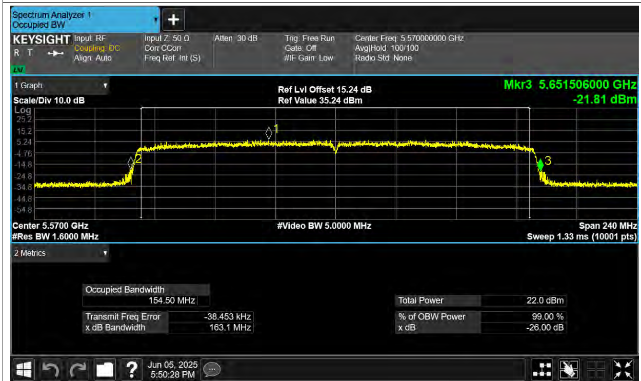
-26dB Bandwidth NVNT ax20 5500MHz Ant1
