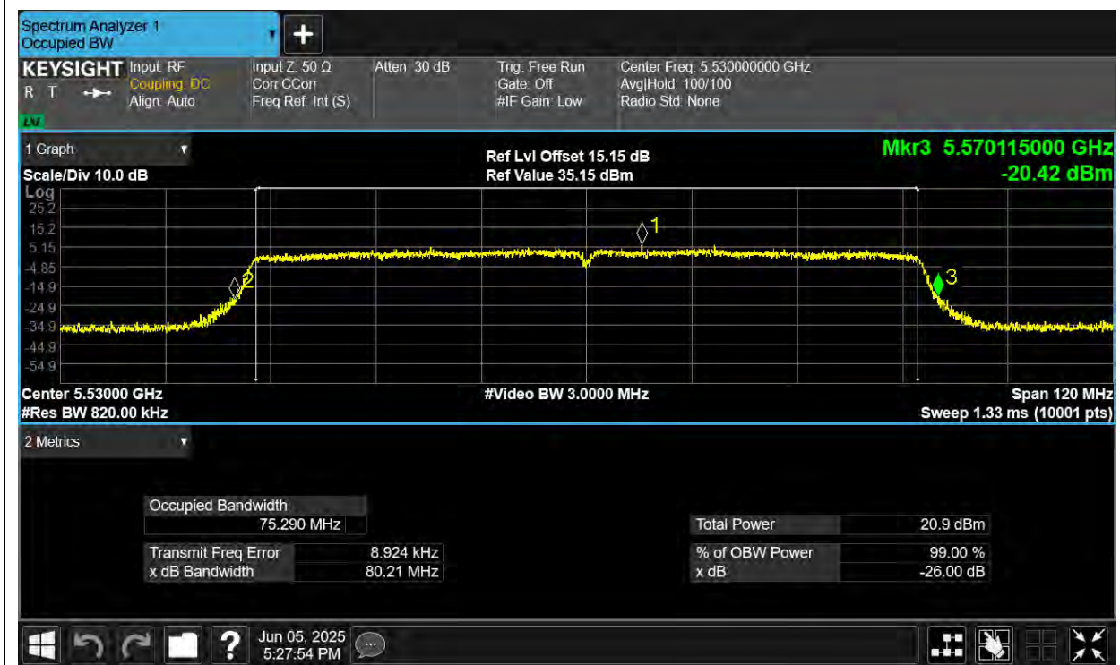
-26dB Bandwidth NVNT ac80 5610MHz Ant1
