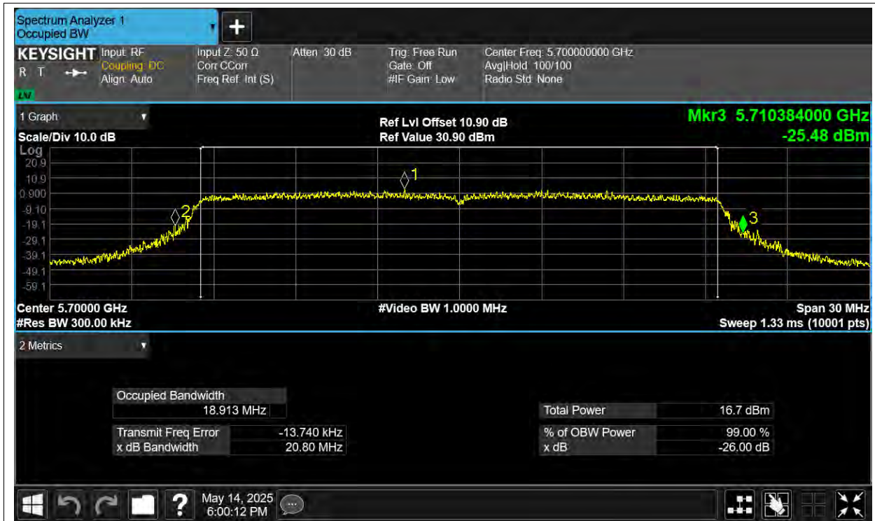
-26dB Bandwidth NVNT ax20 5700MHz Ant2
