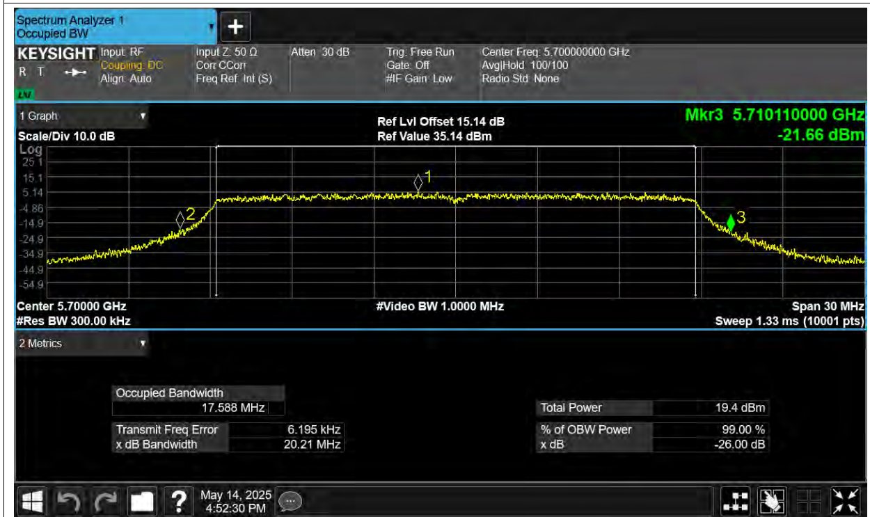
-26dB Bandwidth NVNT n40 5510MHz Ant1
