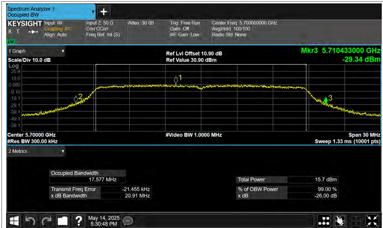
-26dB Bandwidth NVNT ac20 5700MHz Ant2
