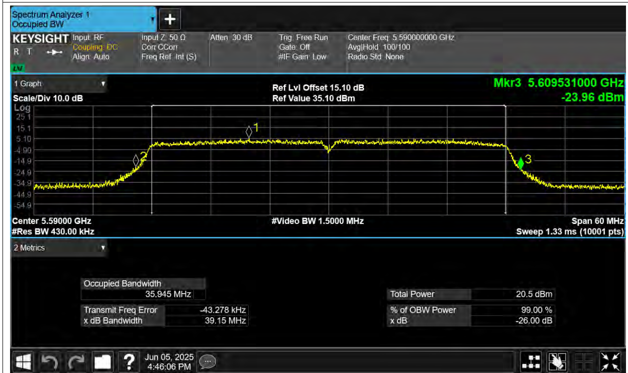
-26dB Bandwidth NVNT n40 5670MHz Ant1
