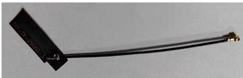
图 2 TYY-TX2506G-3 天线 (线总长是 60+/-2mm 线径 0.81mm 带 4 代端子)
