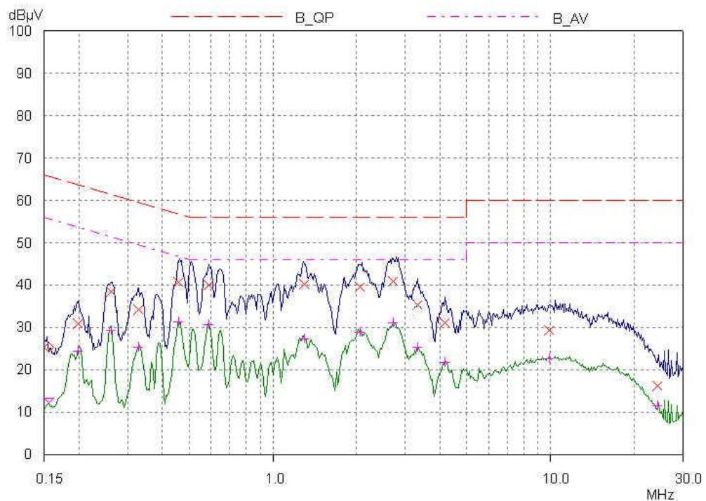
Bluetooth\_8DPSK(3-DH5) : Frequency – 2441 MHz(L1)
