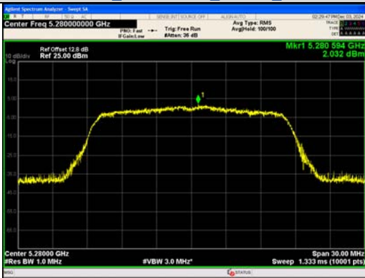
IEEE 802.11a Channel 56 20MHz Antenna 0
