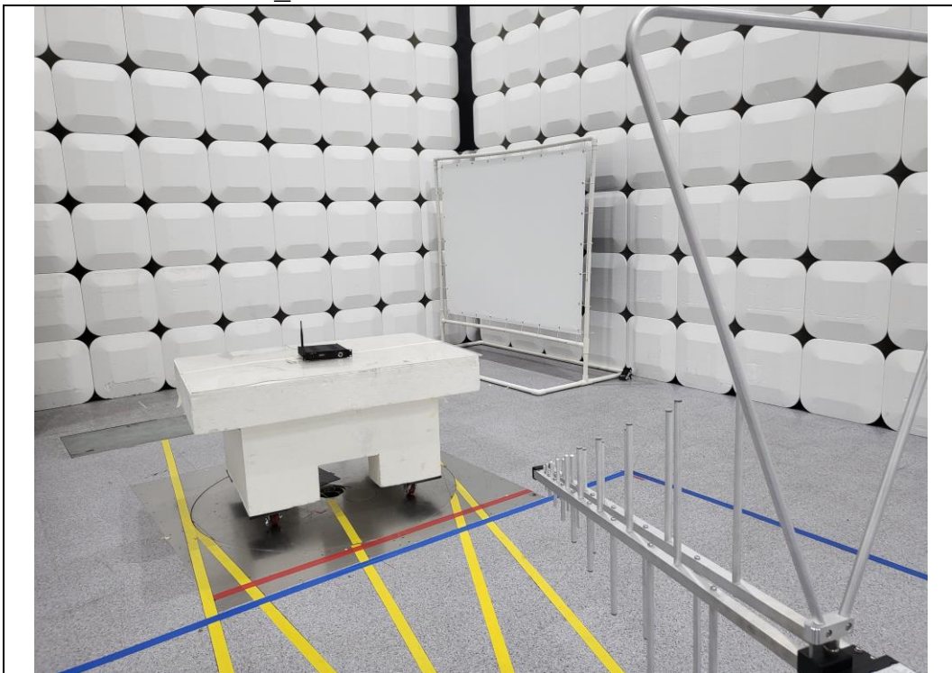
Test distance : 3 m, Height of table : 0.8 m
