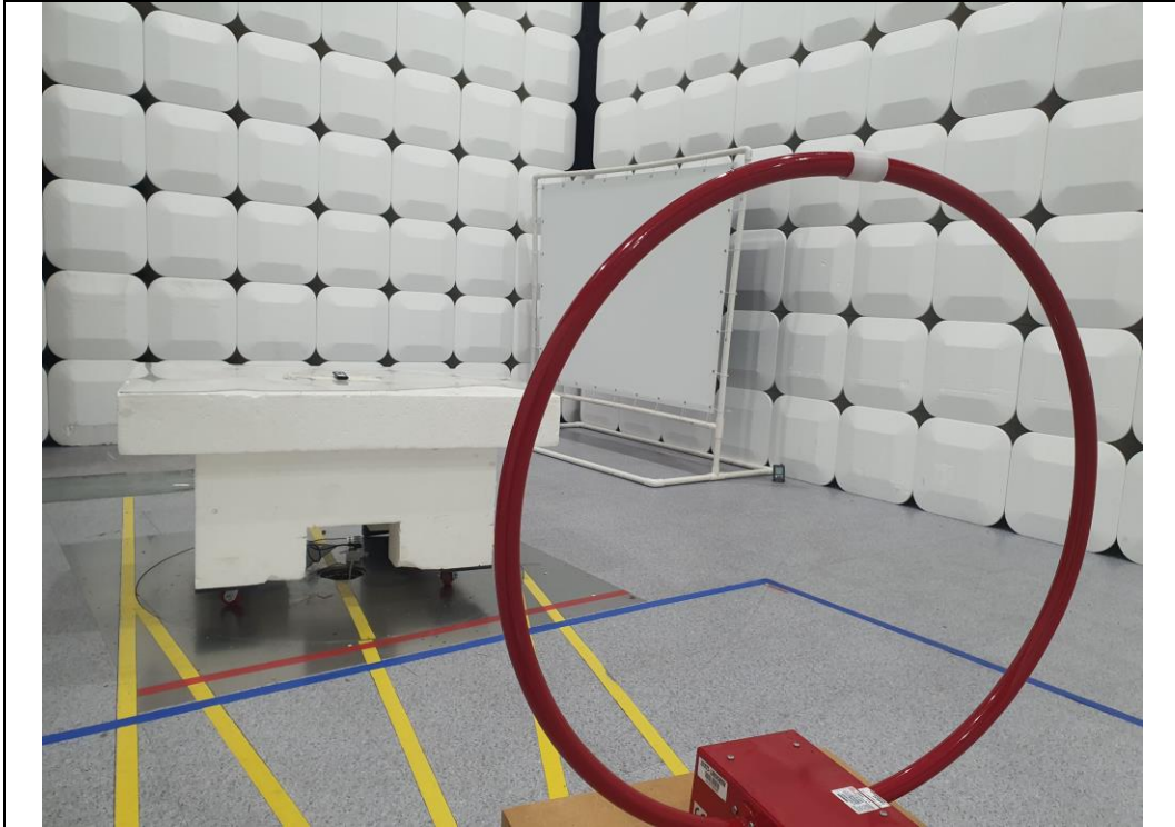
Test distance : 3 m, height of table : 0.8 m
