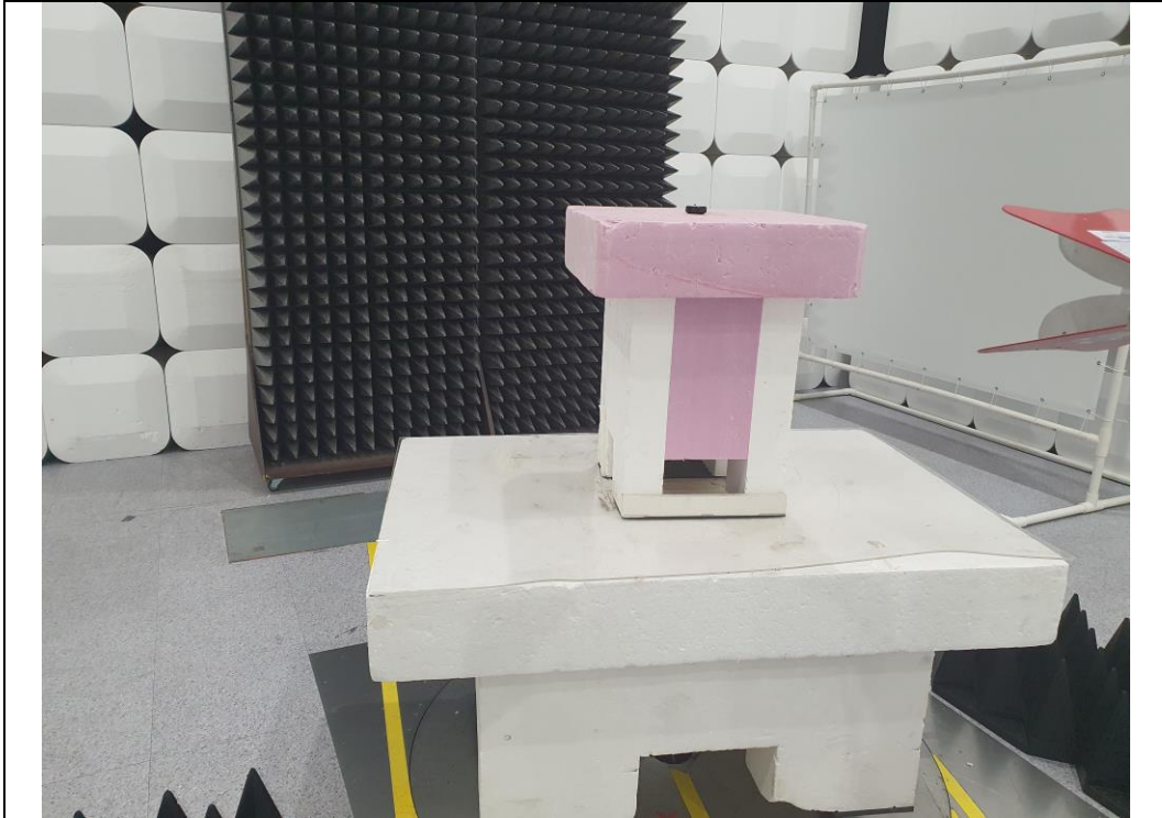
Test distance : 1 m, height of table : 1.5 m
