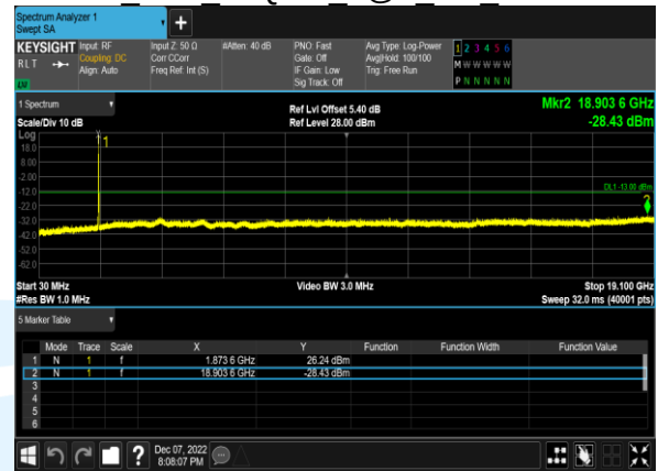
B2_15M 16QAM 1@0 CH 19125
