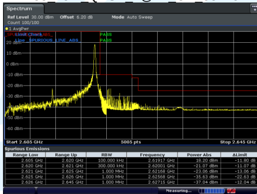
B38 15M QPSK 1@74 CH 38175
