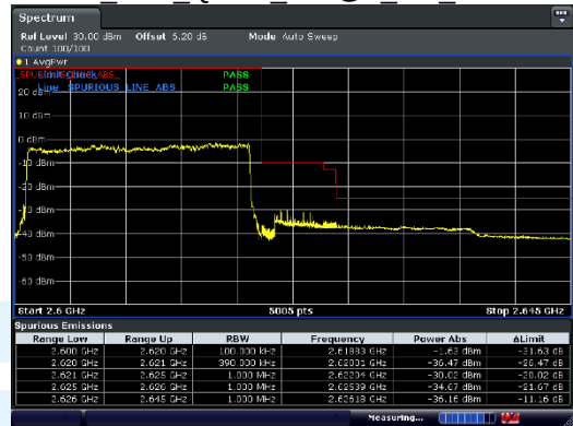
B38 20M QPSK 100@0 CH 38150
