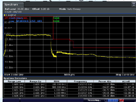
B38 15M QPSK 75@0 CH 38175
