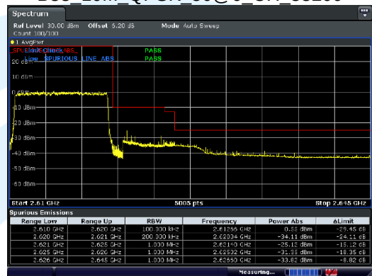
B38 10M QPSK 50@0 CH 38200
