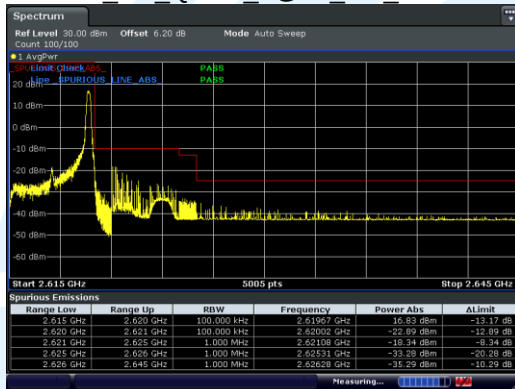
B38 5M QPSK 1@24 CH 38225
