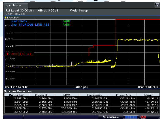
B38 10M QPSK 50@0 CH 37800
