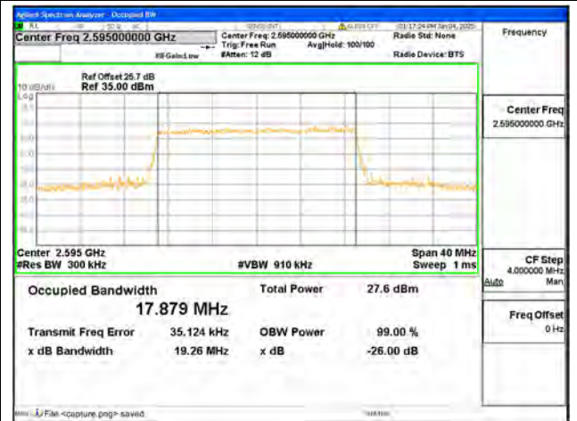
B38 / 20MHz / 16QAM/ Mid CH
