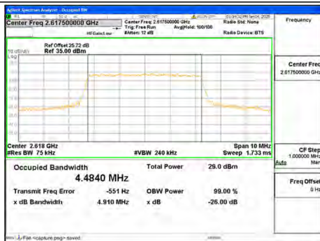
B38 / 5MHz / QPSK/ High CH
