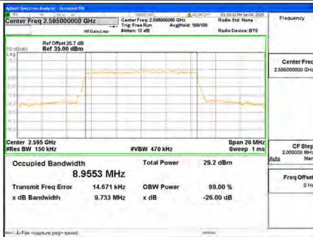
B38 / 10MHz / QPSK/ Mid CH
