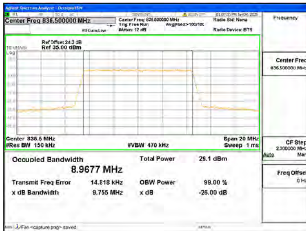
B5 / 10MHz / QPSK/ Mid CH
