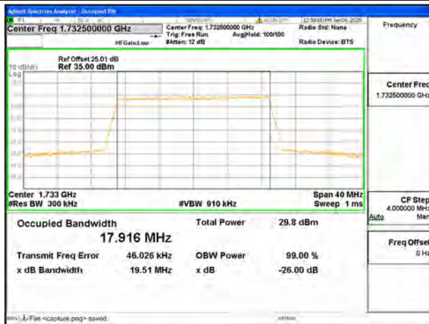
B4 / 20MHz / QPSK/ Mid CH
