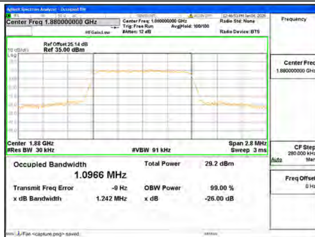
B2 / 1.4MHz / QPSK/ Mid CH
