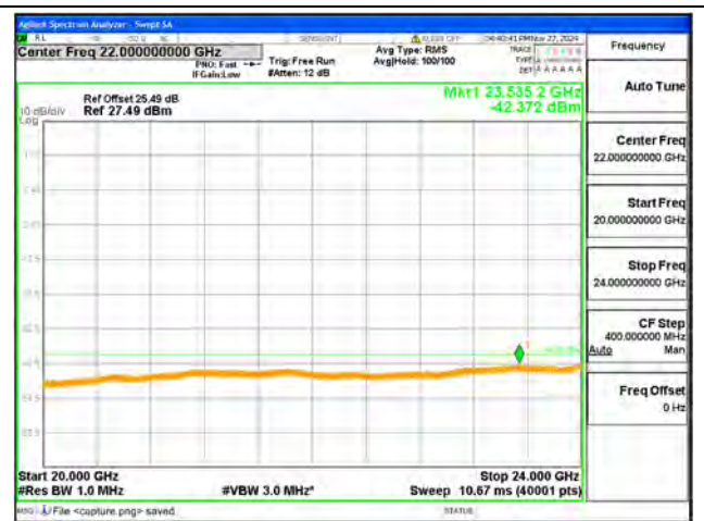
B40-1-20G-24G / 10MHz / Mid CH / QPSK
