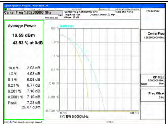
B2 / 5MHz / Low CH / 16QAM
