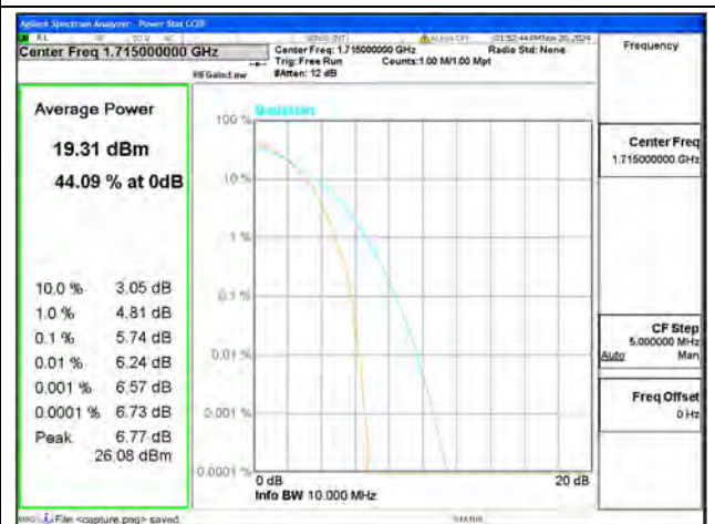
B66 / 10MHz / Low CH / 64QAM
