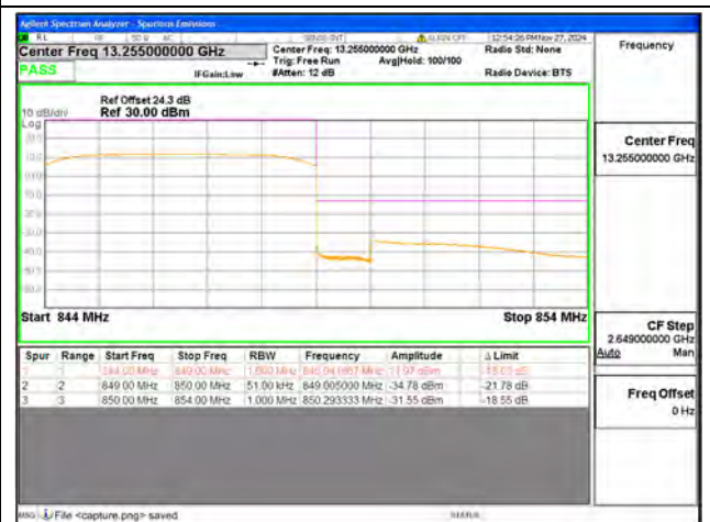
B5 / 5MHz / High CH / QPSK / FULL RB
