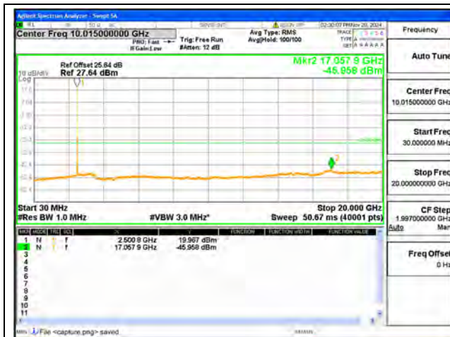
B7-30M-20G / 20MHz / Low CH / QPSK
