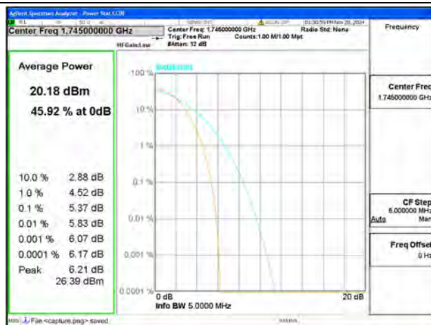
B66 / 5MHz / Mid CH / 16QAM
