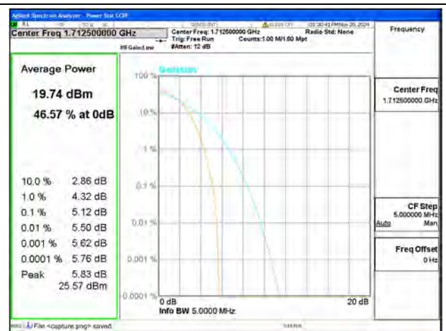
B66 / 5MHz / Low CH / 16QAM
