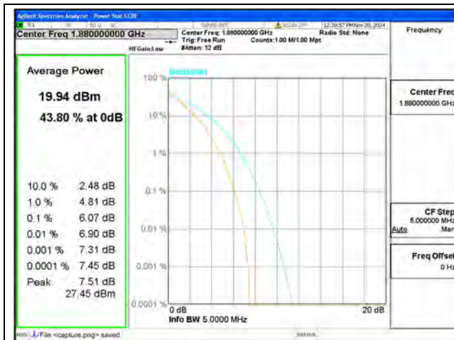
B2 / 3MHz / Mid CH / QPSK
