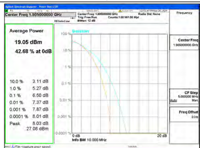
B2 / 10MHz / High CH / 64QAM
