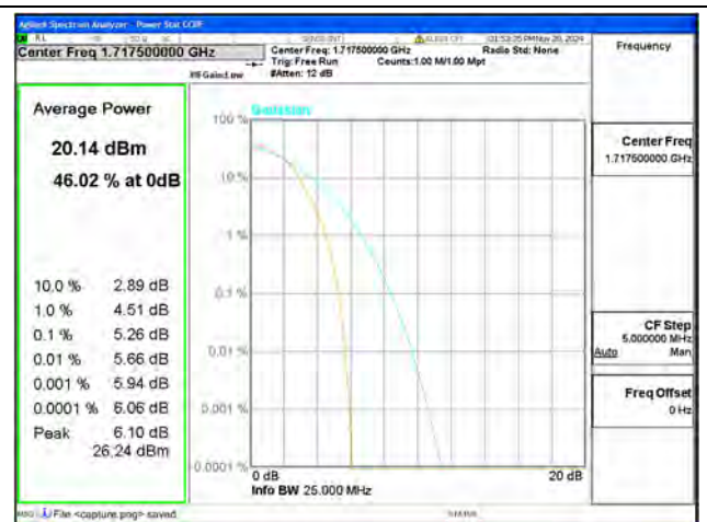
B66 / 15MHz / Low CH / 16QAM
