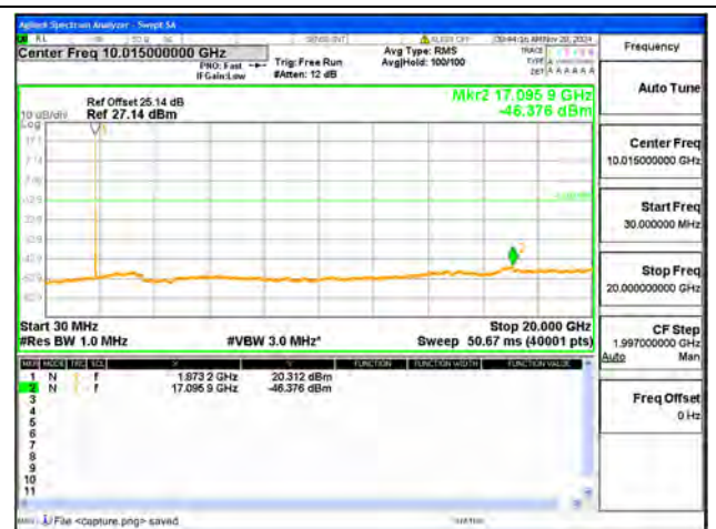
B2 / 15MHz / Mid CH / QPSK
