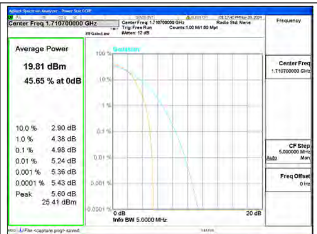
B66 / 1.4MHz / Low CH / 16QAM
