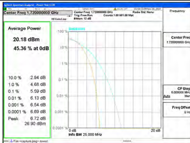
B66 / 20MHz / Low CH / 16QAM
