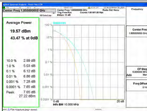
B2 / 10MHz / Low CH / 16QAM
