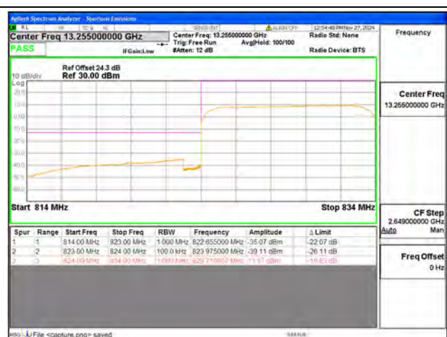
B5 / 10MHz / Low CH / QPSK / FULL RB
