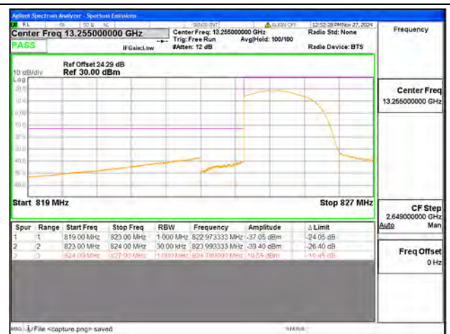
B5 / 1.4MHz / Low CH / QPSK / FULL RB
