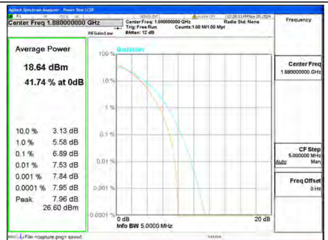
B2 / 1.4MHz / Mid CH / 64QAM
