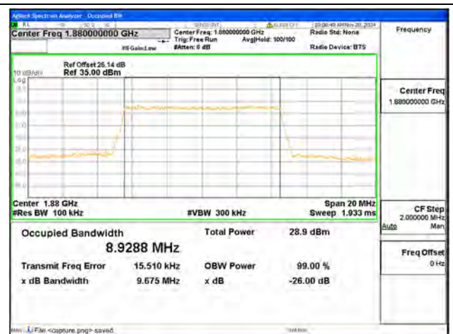
B2 / 10MHz / 16QAM/ Mid CH
