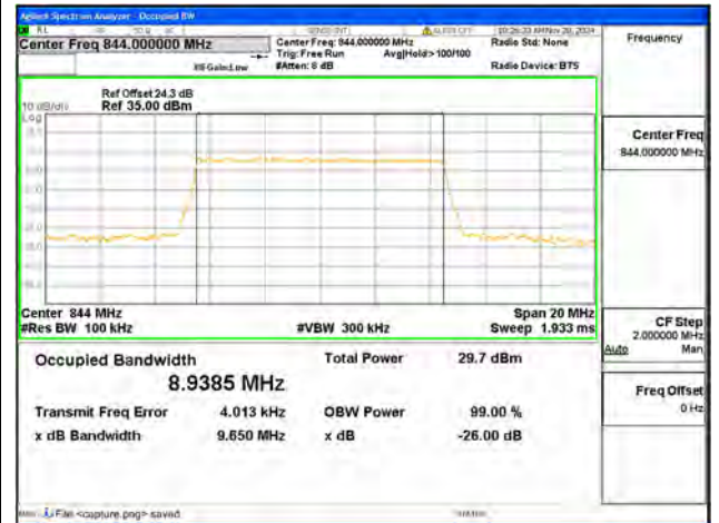
B5 / 10MHz / QPSK/ High CH
