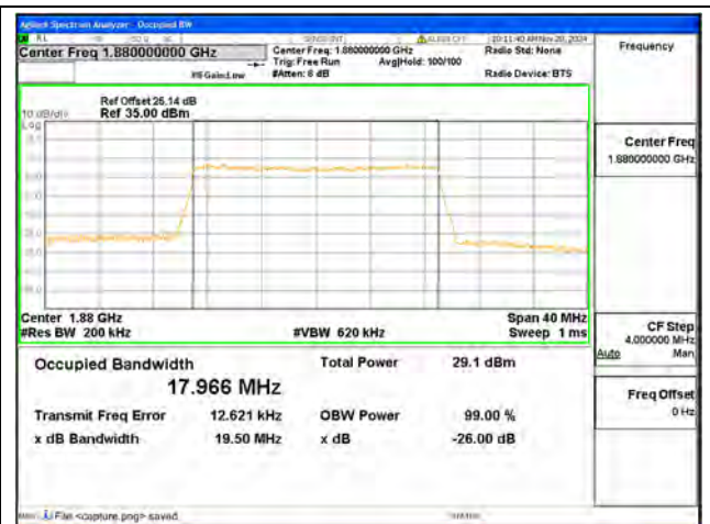
B2 / 20MHz / 16QAM/ Mid CH
