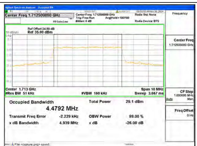
B66 / 5MHz / 16QAM/ Low CH
