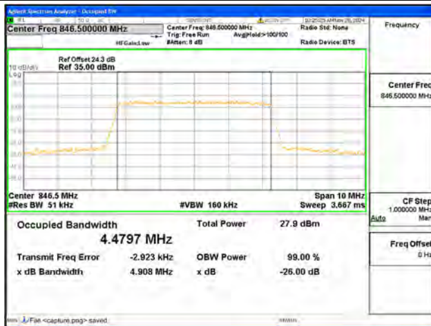
B5 / 5MHz / 64QAM/ High CH
