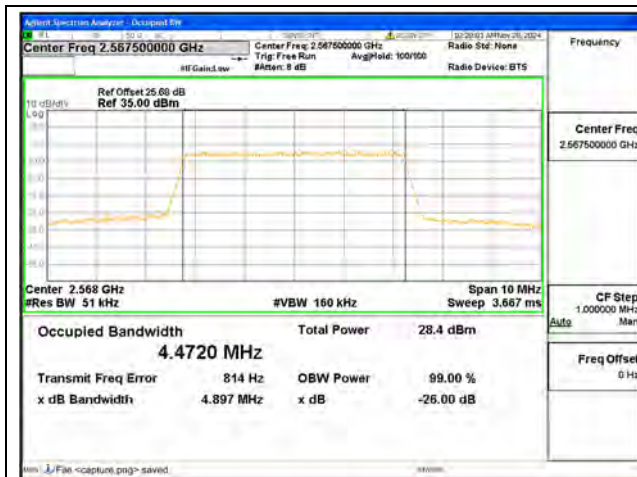
B7 / 5MHz / QPSK/ High CH
