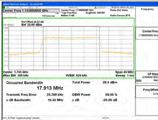
B66 / 20MHz / 64QAM/ Mid CH
