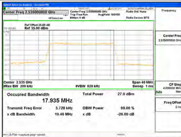
B7 / 20MHz / 64QAM/ Mid CH
