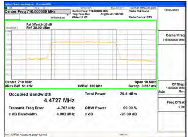
B17 / 5MHz / QPSK/ Mid CH
