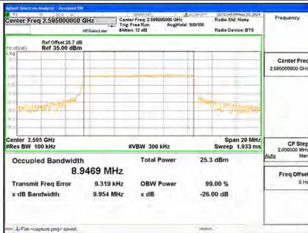
B38 / 10MHz / 64QAM/ Mid CH
