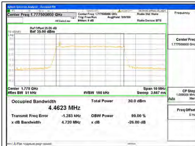
B66 / 5MHz / QPSK/ High CH
