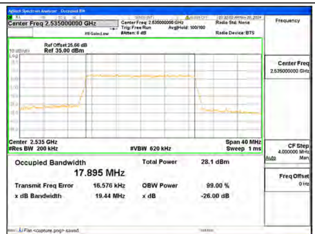
B7 / 20MHz / 16QAM/ Mid CH
