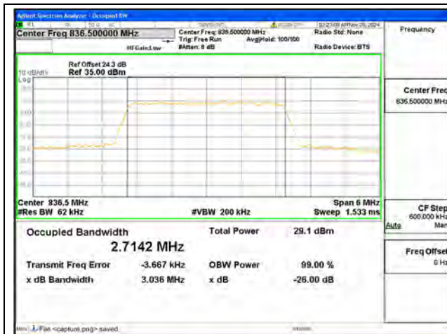
B5 / 3MHz / QPSK/ Mid CH
