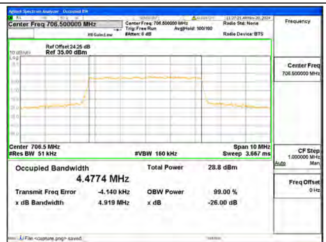
B17 / 5MHz / 16QAM/ Low CH
