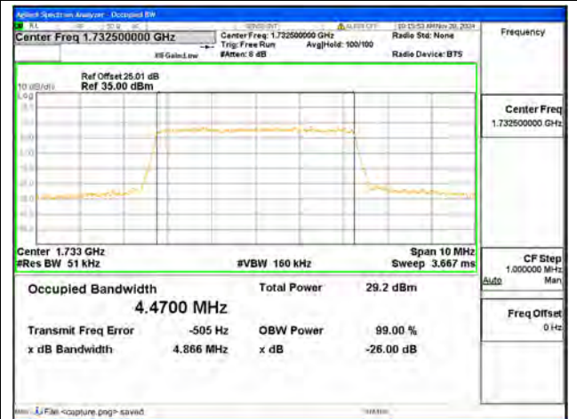
B4 / 5MHz / QPSK/ Mid CH
