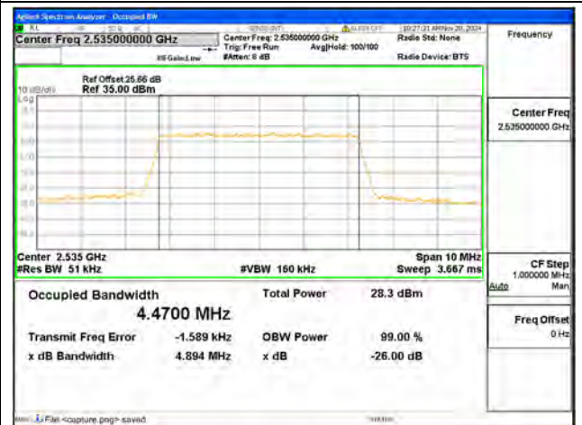
B7 / 5MHz / QPSK/ Mid CH
