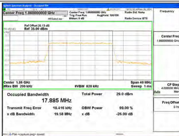
B2 / 20MHz / 16QAM/ Low CH
