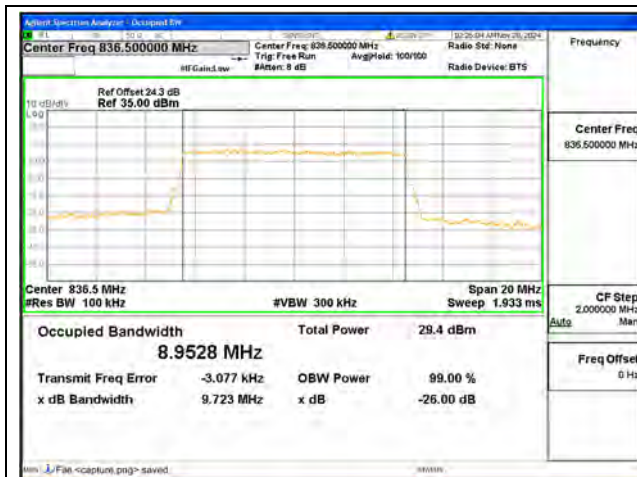
B5 / 10MHz / QPSK/ Mid CH
