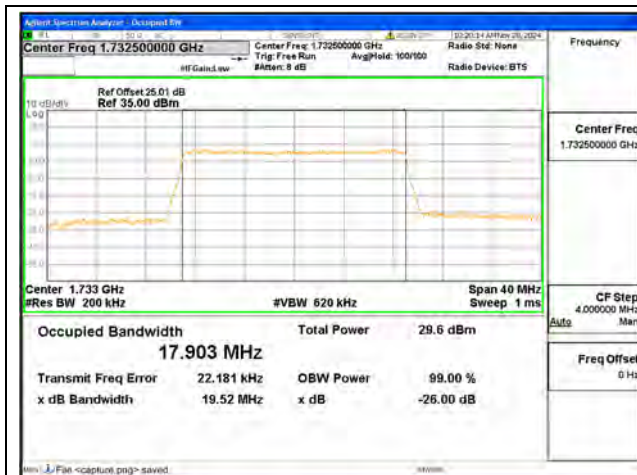
B4 / 20MHz / QPSK/ Mid CH
