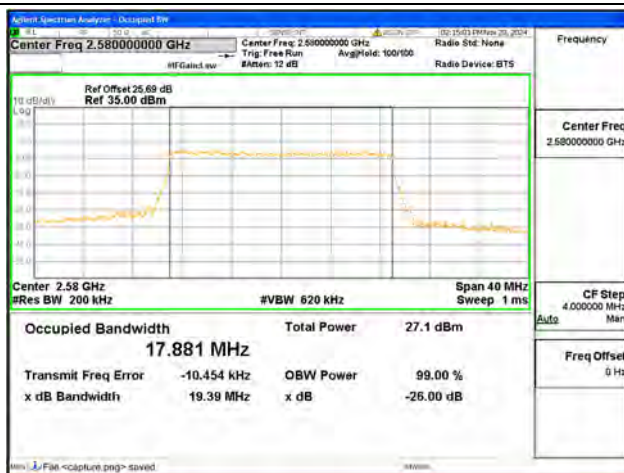
B38 / 20MHz / 16QAM/ Low CH
