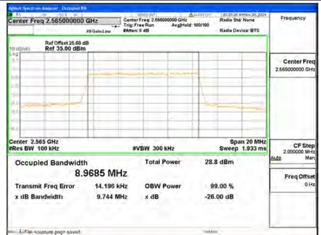
B7 / 10MHz / QPSK/ High CH
