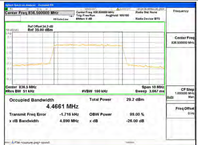
B5 / 5MHz / QPSK/ Mid CH
