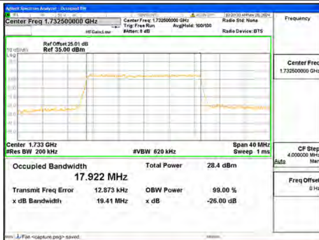
B4 / 20MHz / 64QAM/ Mid CH
