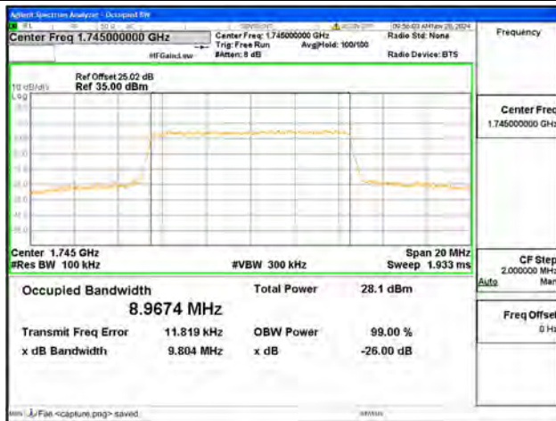
B66 / 10MHz / 64QAM/ Mid CH
