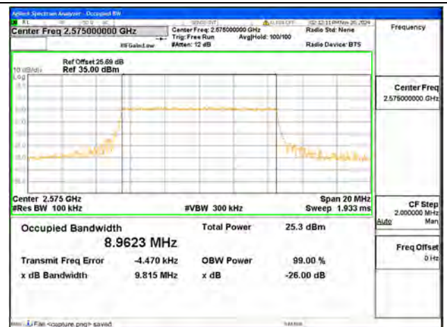
B38 / 10MHz / 64QAM/ Low CH
