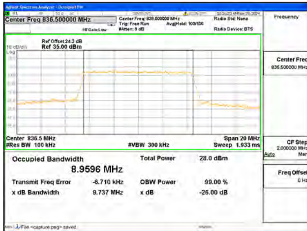
B5 / 10MHz / 64QAM/ Mid CH
