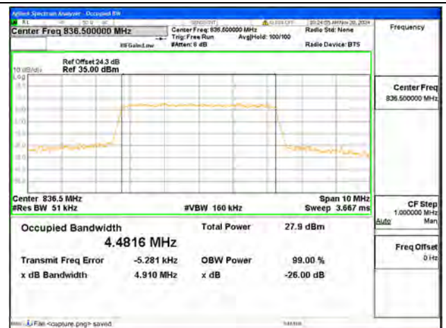
B5 / 5MHz / 64QAM/ Mid CH
