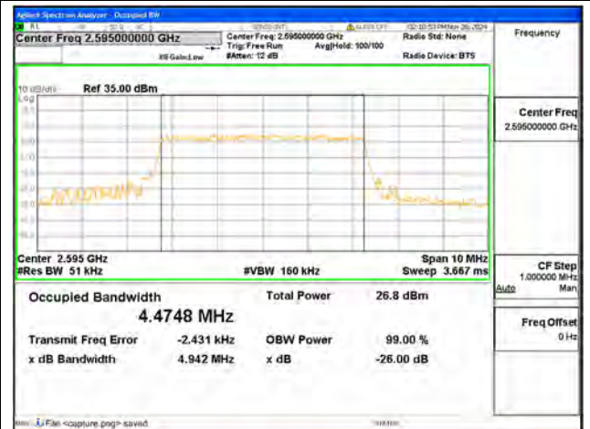
B38 / 5MHz / QPSK/ Mid CH
