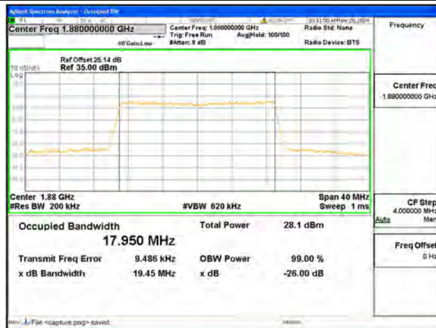
B2 / 20MHz / 64QAM/ Mid CH
