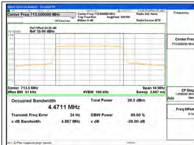
B17 / 5MHz / QPSK/ High CH
