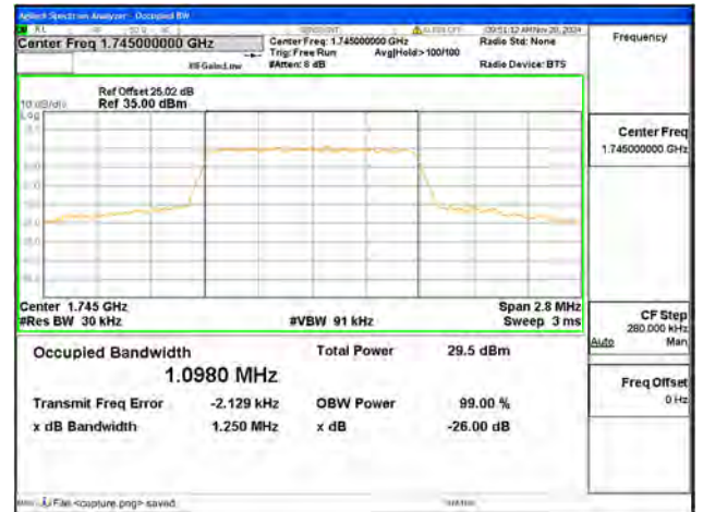
B66 / 1.4MHz / QPSK/ Mid CH
