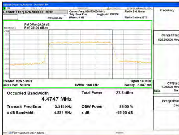
B5 / 5MHz / 64QAM/ Low CH
