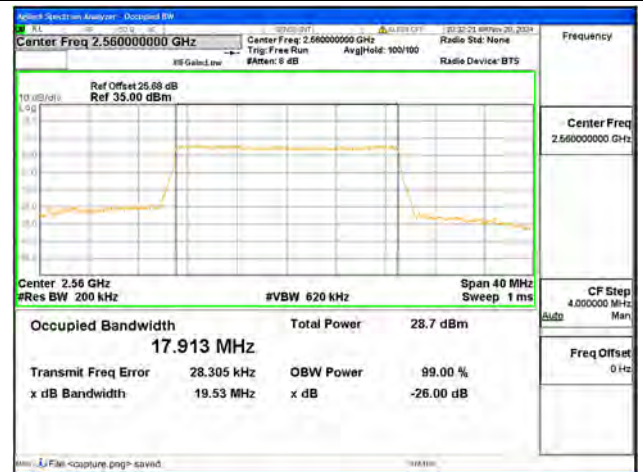
B7 / 20MHz / QPSK/ High CH
