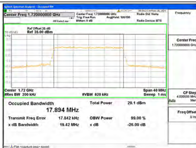
B66 / 20MHz / 16QAM/ Low CH
