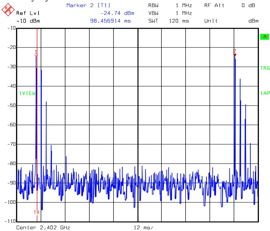
Duty Cycle at  $\pi/4$ DPSK ch0 DH3 channel: number of 100ms
