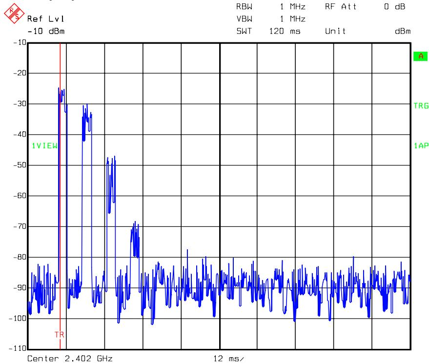
Duty Cycle at 8DPSK ch0 DH1 channel: number of 100ms
