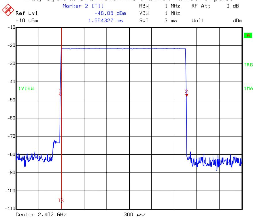
Duty Cycle at GFSK ch0 DH5 channel: number of pulse
