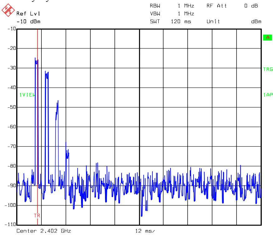
Duty Cycle at  $\pi/4$ DPSK ch0 DH5 channel: number of 100ms
