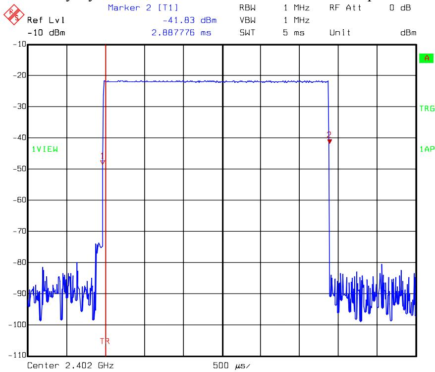
Duty Cycle at  $\pi/4$ DPSK ch0 DH1 channel: number of pulse
