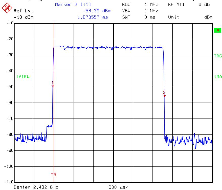
Duty Cycle at  $\pi/4$ DPSK ch0 DH5 channel: number of pulse
