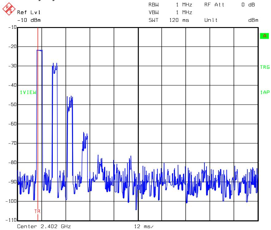
Duty Cycle at  $\pi/4$ DPSK ch0 DH1 channel: number of 100ms
