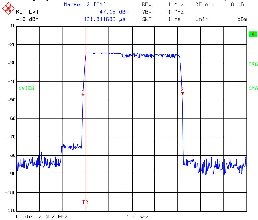
Duty Cycle at  $\pi/4$ DPSK ch0 DH3 channel: number of pulse
