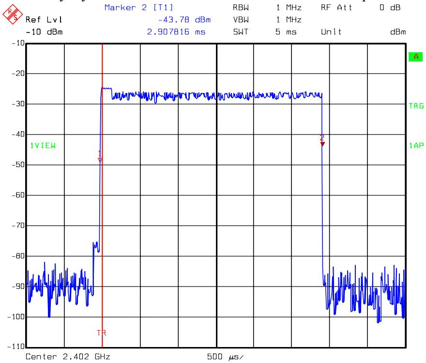
Duty Cycle at GFSK ch0 DH1 channel: number of 100ms
