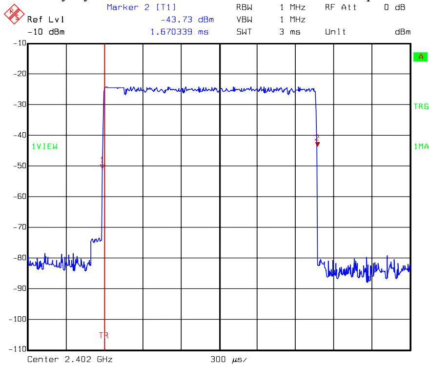
Duty Cycle at 8DPSK ch0 DH5 channel: number of pulse
