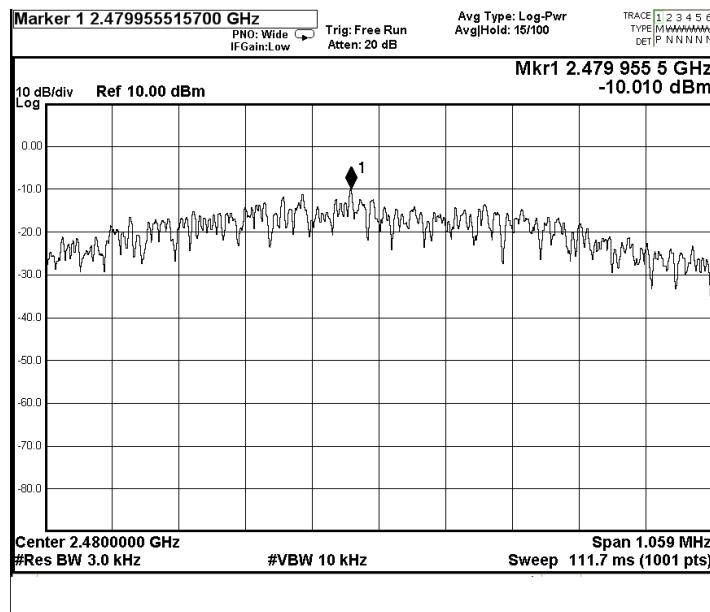
Tx mode GFSK 2Mbps (Tx: 2402MHz to 2480MHz)
