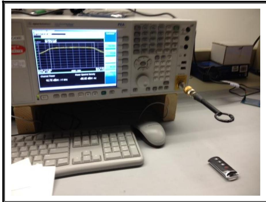
**RADIATED EMISSION FOR PORTABLE CONFIGURATION – X ORIENTATION**
