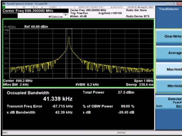
NB-IoT Band 12 QPSK 15KHz 1@0 CH-Low
