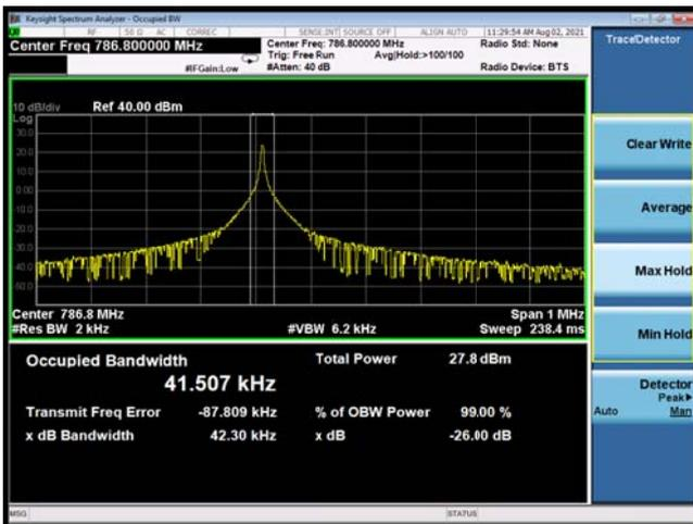
NB-IoT Band 13 QPSK 15KHz 1@0 CH-High
