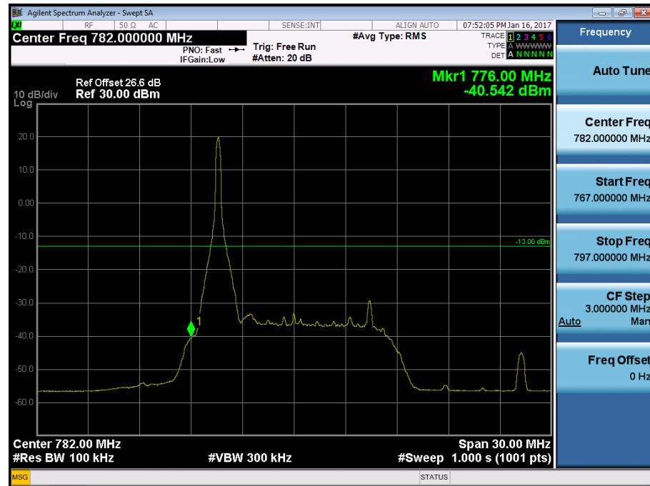
Band 13 Upper Band Edge Plot (5M BW Ch.23255 QPSK\_RB25)
