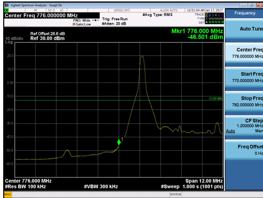
Band 13 Lower Band Edge Plot (5M BW Ch.23205 QPSK\_RB25)
