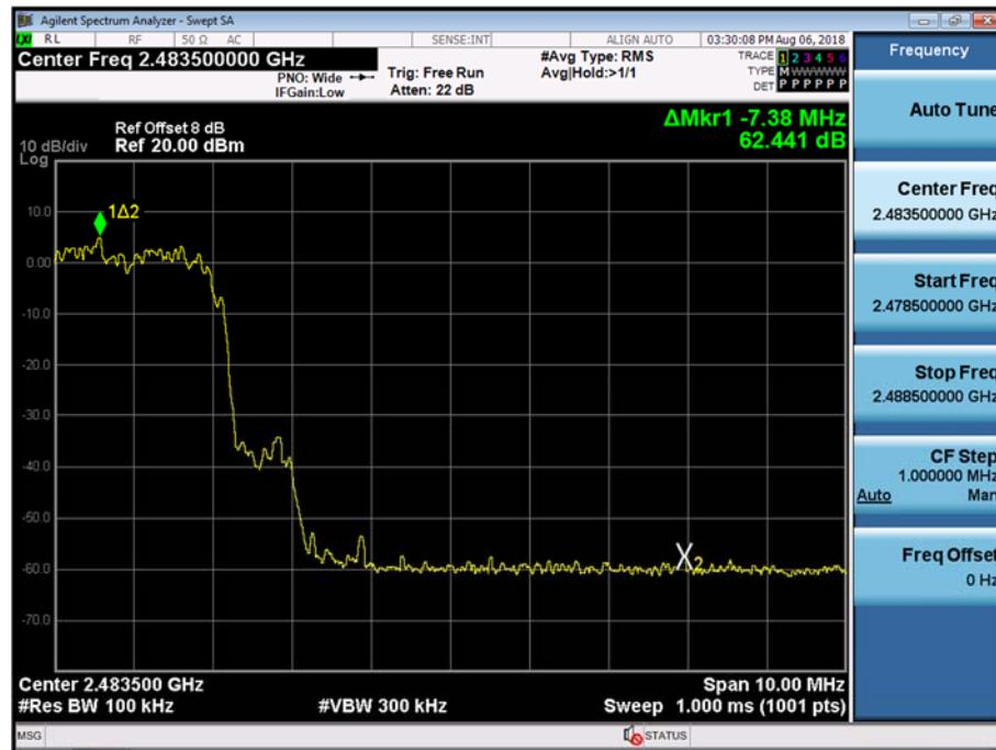
Test Plots with hopping ( $\pi/4$ DQPSK)
