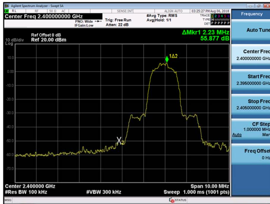
Test Plots without hopping ( $\pi/4$ DQPSK)
