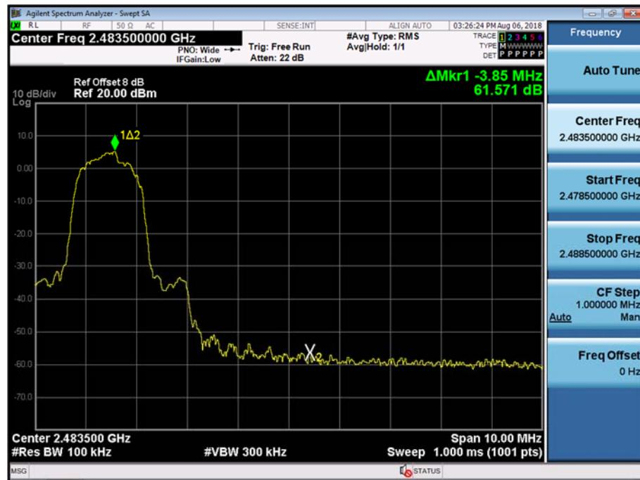
Test Plots without hopping ( $\pi/4$ DQPSK)
