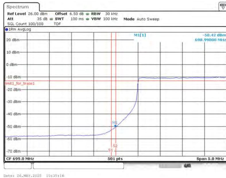
**HIGH BAND EDGE BLOCK-10MHz+10MHz-100%RB**
