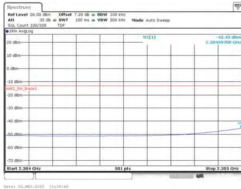
**LOW BAND EDGE BLOCK-10MHz+10MHz-100%RB**
