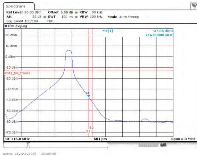
**LOW BAND EDGE BLOCK-10MHz+10MHz-100%RB**
