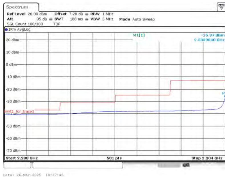
**HIGH BAND EDGE BLOCK-10MHz+10MHz-100%RB**
