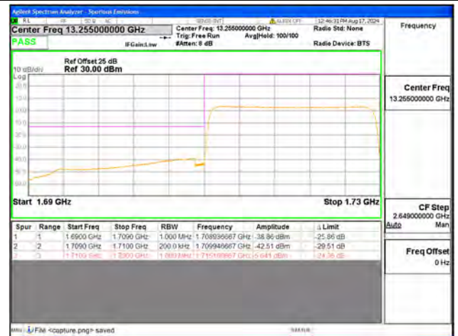
B66 / 20MHz / Low CH / QPSK / FULL RB
