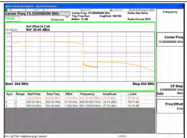
B5 / 5MHz / High CH / QPSK / FULL RB
