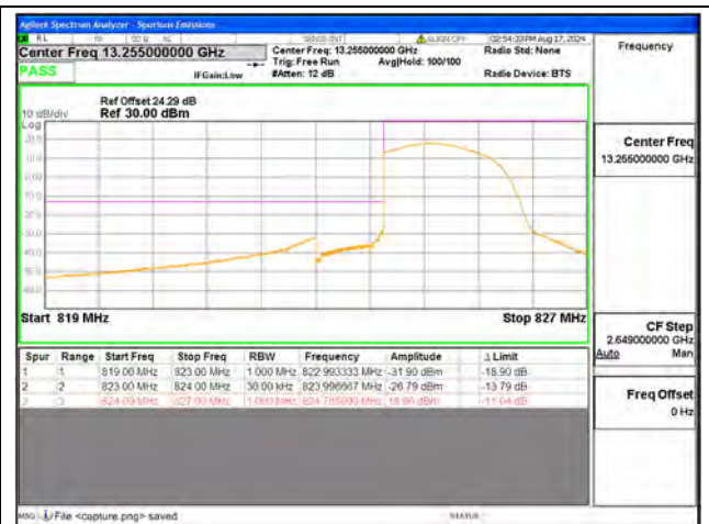
B5 / 1.4MHz / Low CH / QPSK / FULL RB
