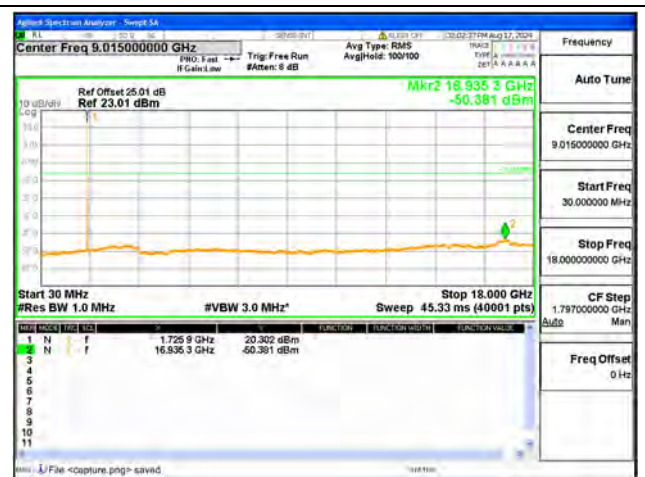
B4 / 15MHz / Mid CH / QPSK
