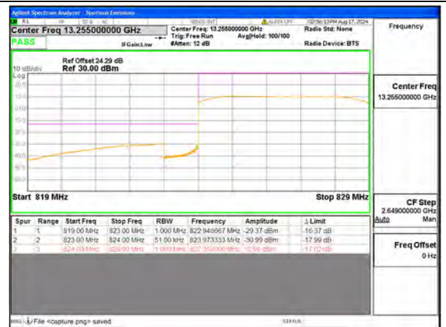
B5 / 5MHz / Low CH / QPSK / FULL RB
