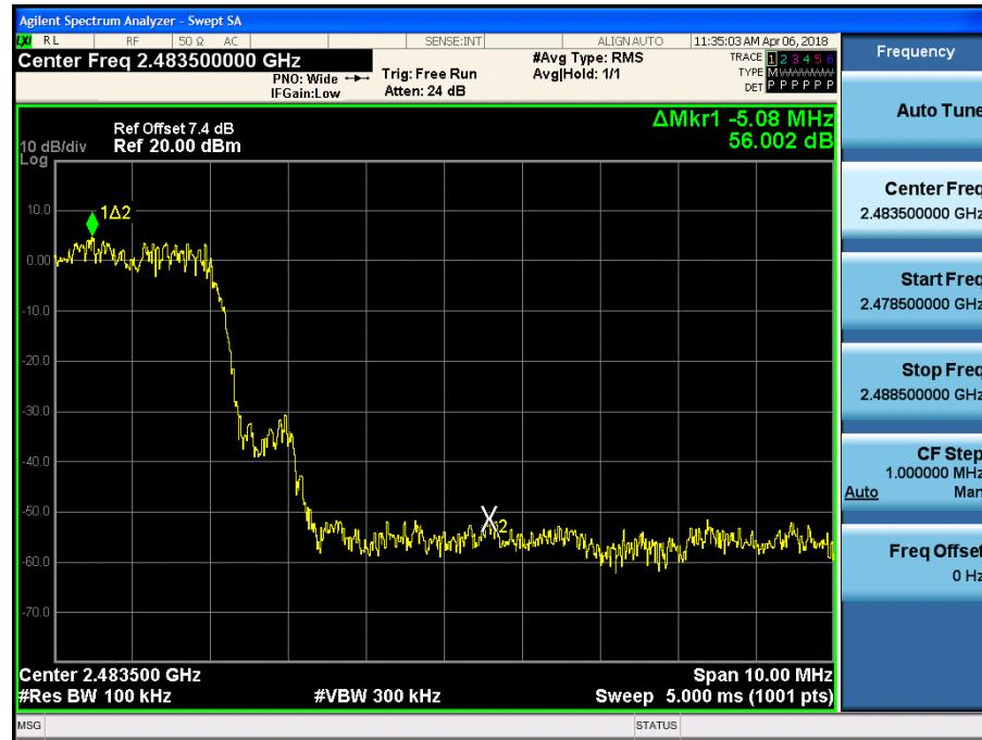
Test Plots with hopping ( $\pi/4$ DQPSK)
