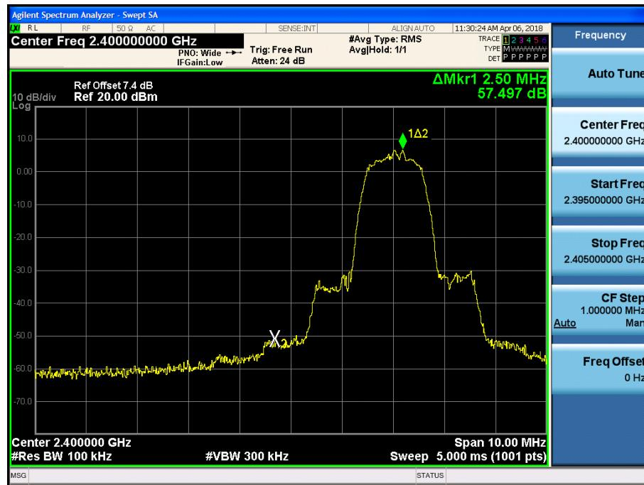
Test Plots without hopping ( $\pi/4$ DQPSK)
