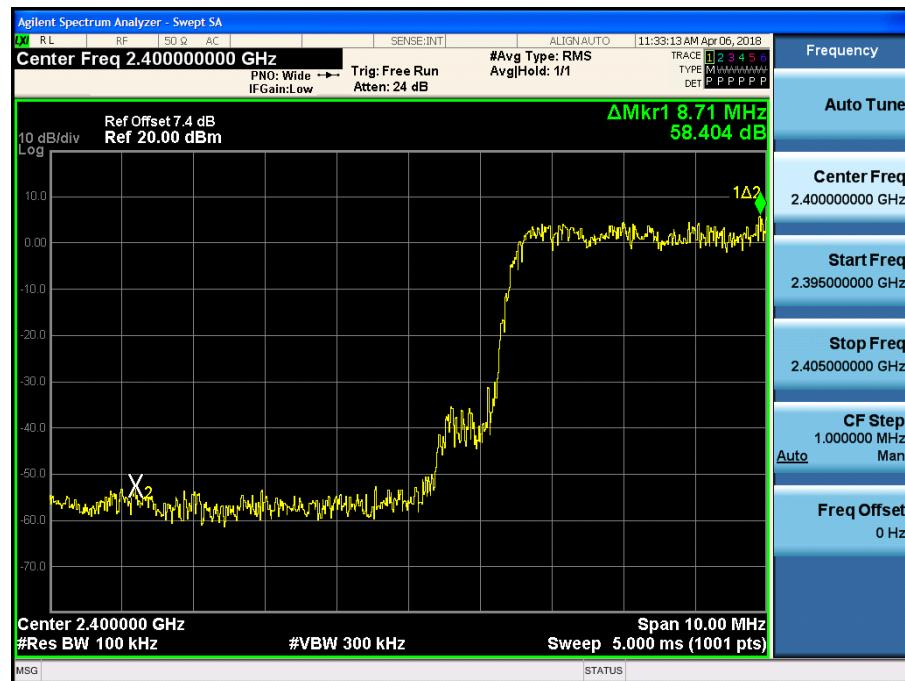
Test Plots with hopping ( $\pi/4$ DQPSK)
