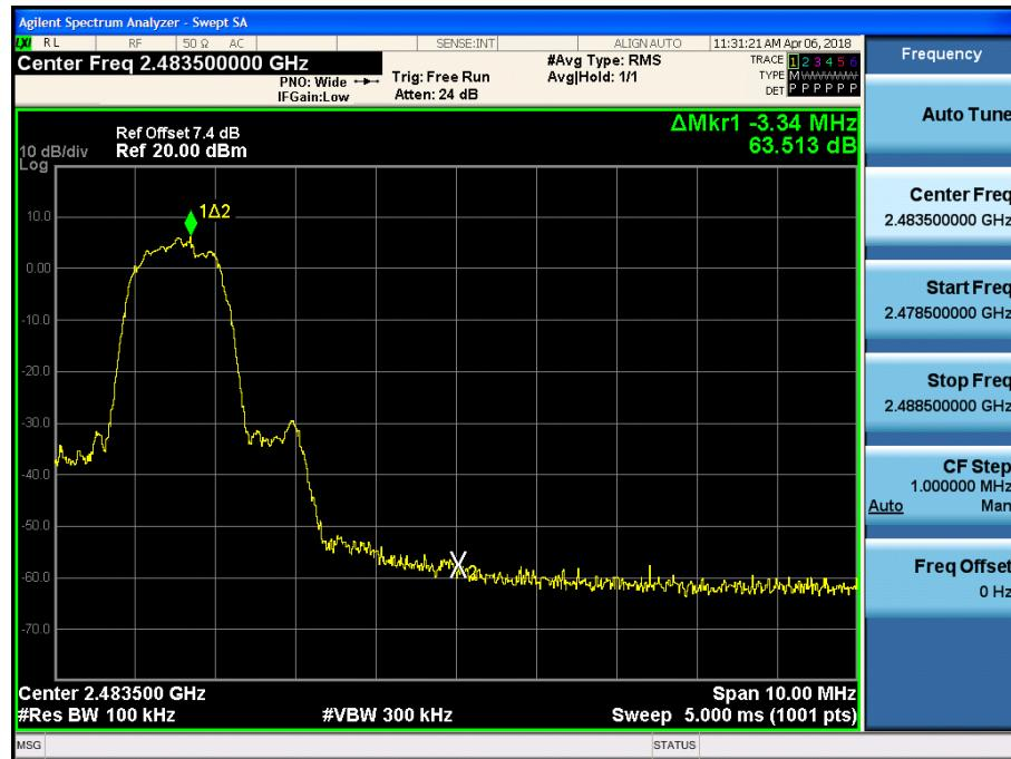
Test Plots without hopping ( $\pi/4$ DQPSK)
