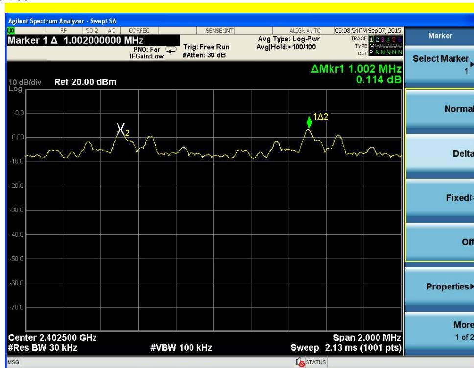
Modulation Standard:  $\pi/4$ -DQPSK (2Mbps)
