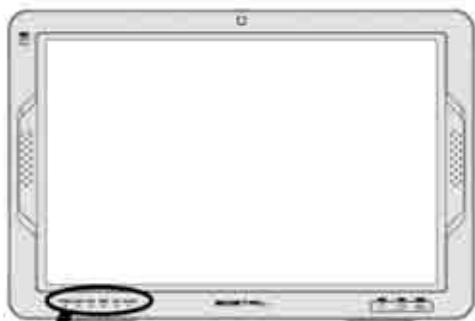
POWER SLEEP HOLD BEAM HDD CHARGE
