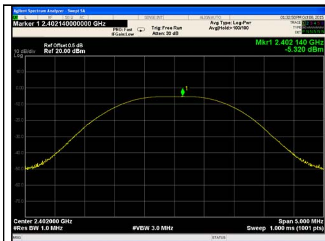
AV Output power - Low CH 2402
