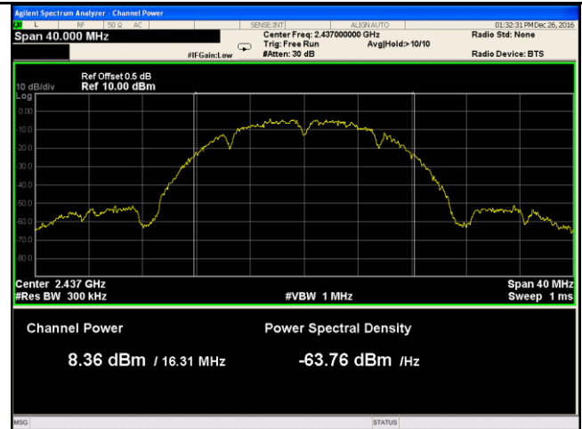
802.11b - AV Output power - Mid CH 2437
