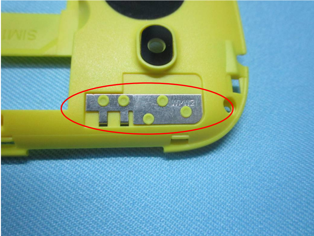
Bluetooth / BLE / WIFI Antenna View
