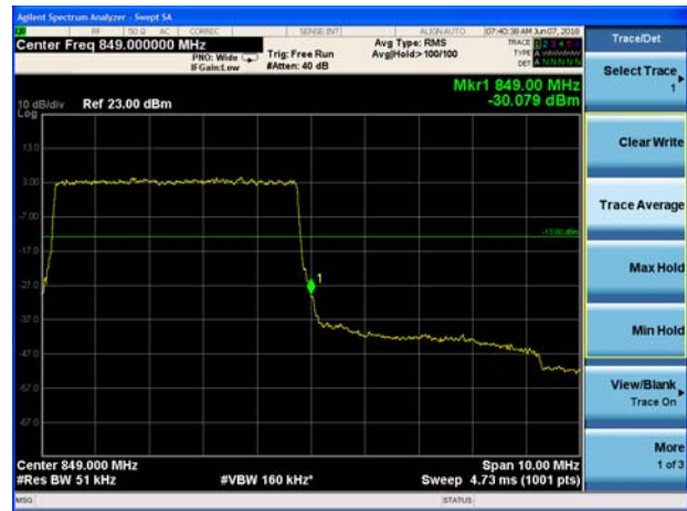
LTE Band 5 QPSK 10MHz CH-High 1RB
