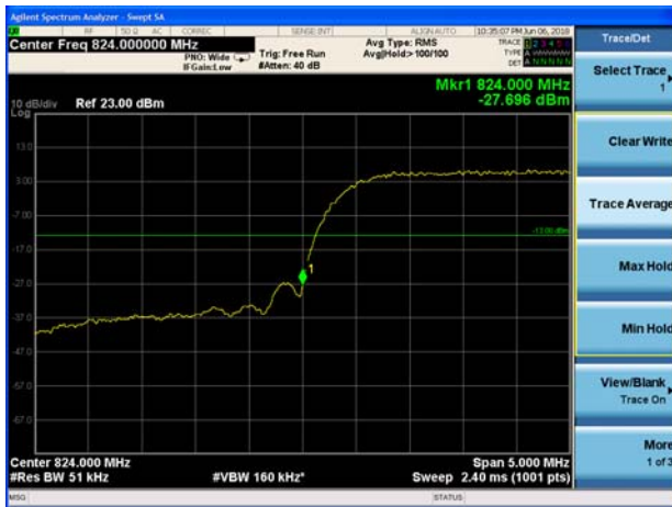
LTE Band 5 QPSK 1.4MHz CH-Low 1RB
