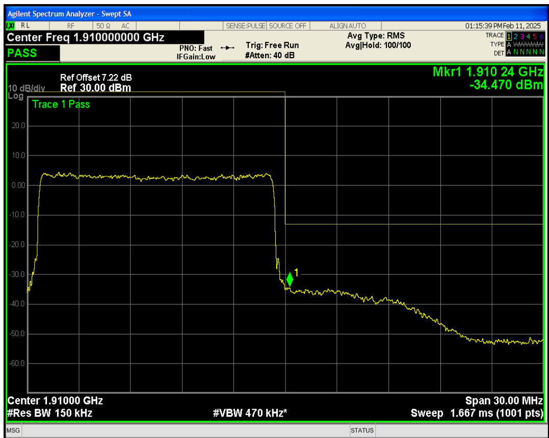
Band2 QPSK BW=20MHz Channel=18700 RB Size=100 Position=#0
