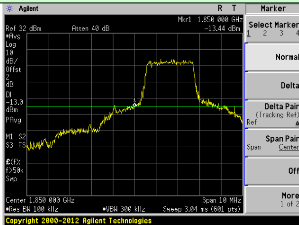
5MHz Bandwidth (RB size:12# RB offset:0#)
