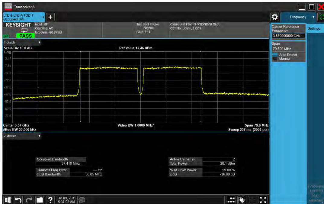
LTE CA intra-band 48 / 40(20+20) / QPSK - RB Size 200(100+100)
